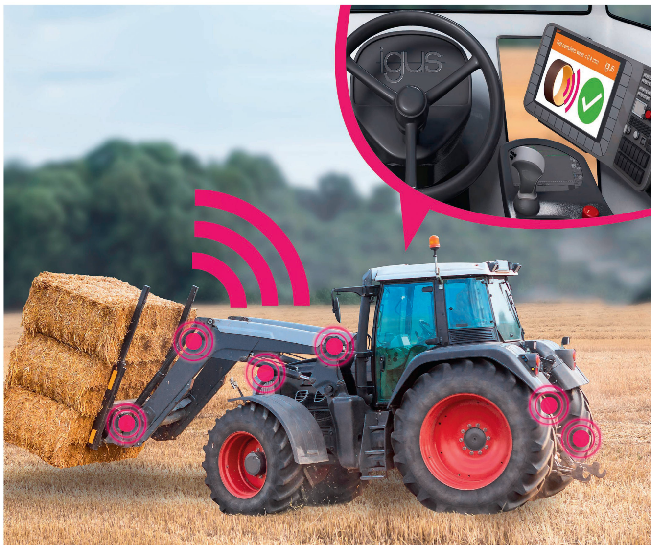
Erstes intelligentes Lager: Das Lager aus Iglidur-Hochleistungskunststoffen der deutschen Firma Igus erkennt den Verschleiss und warnt rechtzeitig vor einem Ausfall. Bild: Igus
