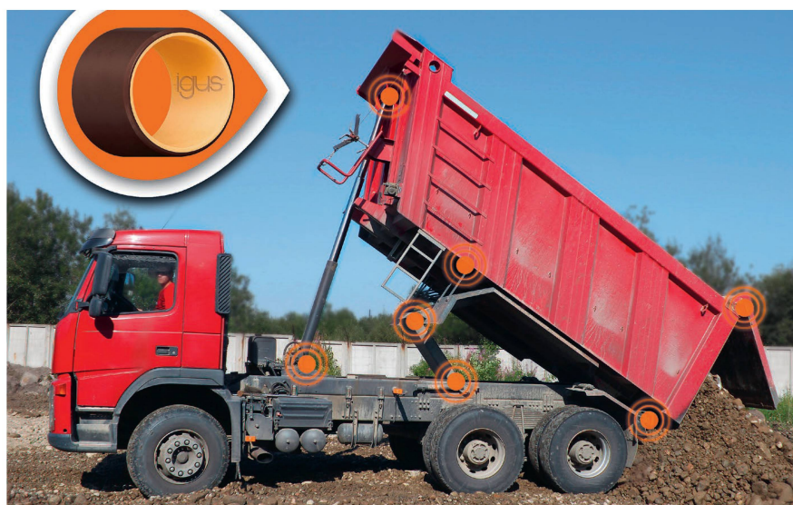
Schmierfreie Polymer-Gleitlager kommen auch in schweren Maschinen zum Einsatz. Die harte polymere Schale schützt das Schwerlastlager.
