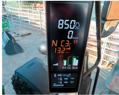
Im Eckpostendisplay werden Informationen zu Motor und Getriebe angezeigt.
