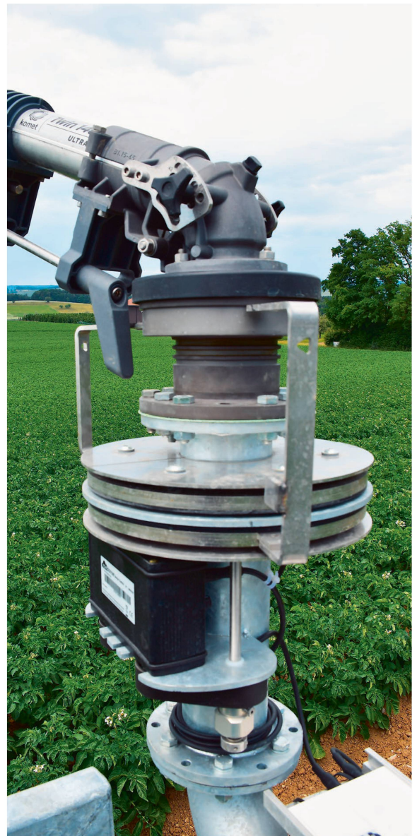
Automatische Sektor-Steuerung: Beregnungsstart 180° Richtung Feld, es ist keine Vorberegnung notwendig.
