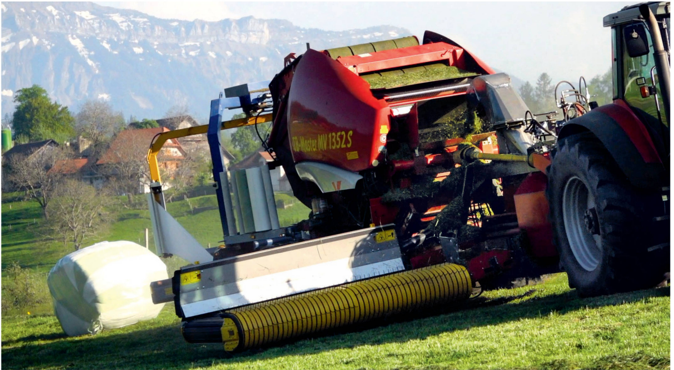
Die Kombination aus Häcksler, Presse und Wickler ist kompakt gebaut und entsprechend wendig. Bilder: R. Burkhalter
