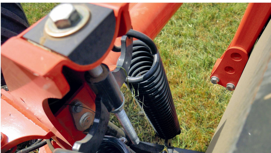
Die Geräteentlastung erfolgt über vier Federn je Pickup, die Einstellung mit einem Schraubenschlüssel über ein Gewinde.
