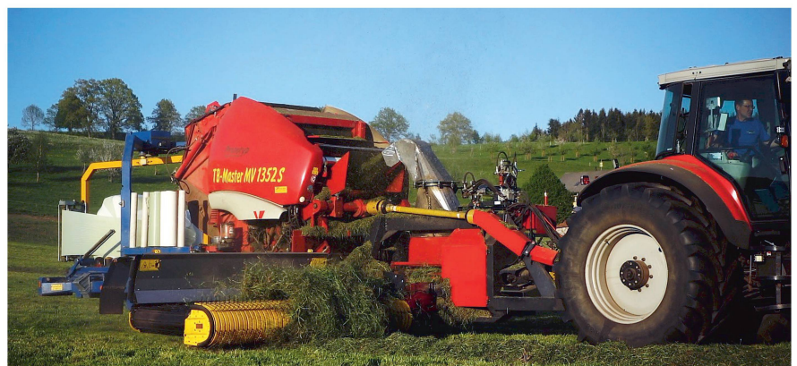
Das Verteilergetriebe teilt die Leistung des Traktors auf den Häcksler, die Presse und auf eine Bordhydraulik für den Bandschwader auf.
