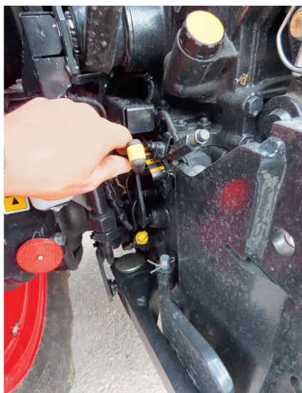
Die Schaltung für die Zapfwellendrehzahl muss extern im Heck vorgenommen werden.
