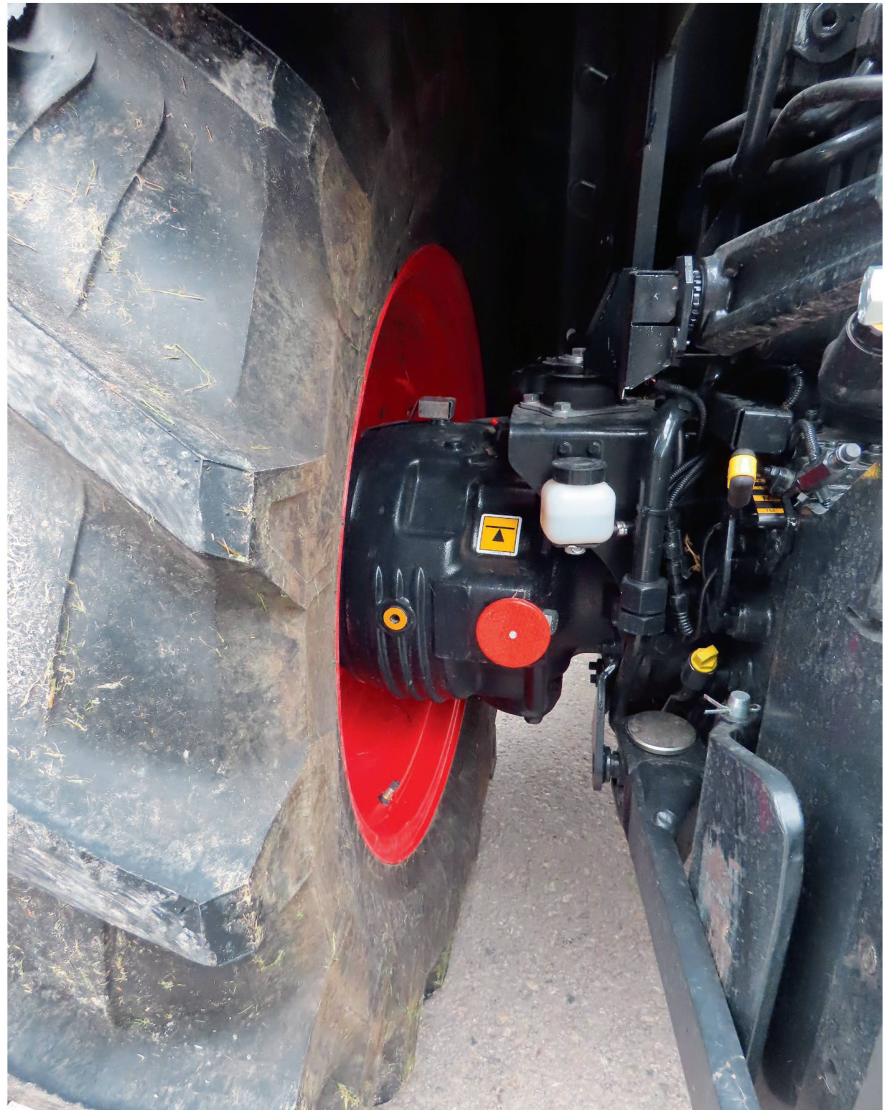
Die Räder an der hinteren Achse können bis zu 18° einschlagen.
