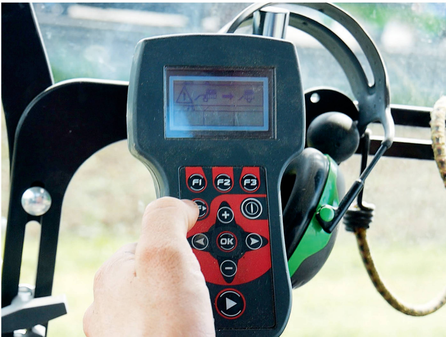
Für die Bedienung in der Kabine gibt es eine einfache, nicht Isobus-kompatible Konsole.
