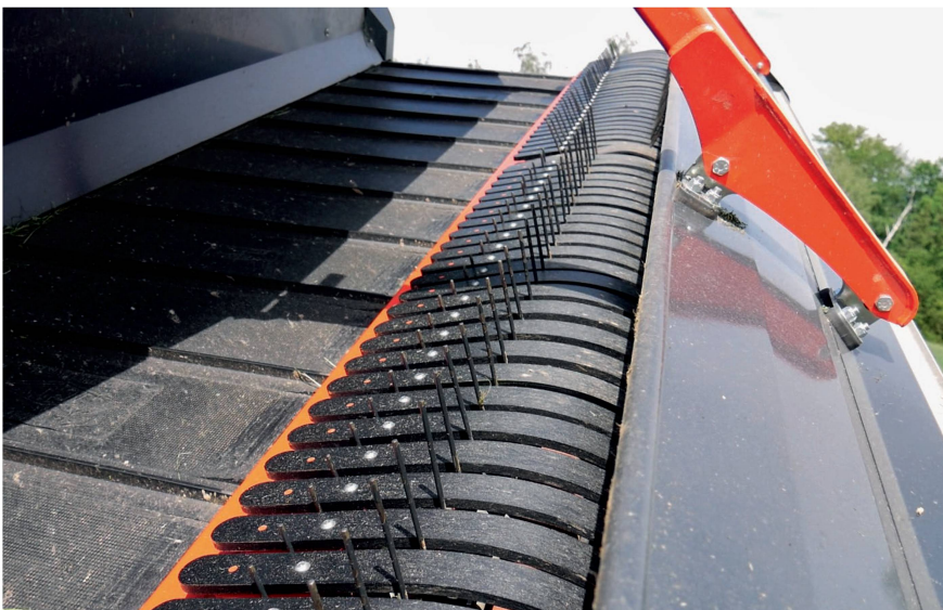
Gesteuertes Pickup mit Kunststoff-Abstreifern und das mit Gewebeeinlagen verstärkte Querförderband.
