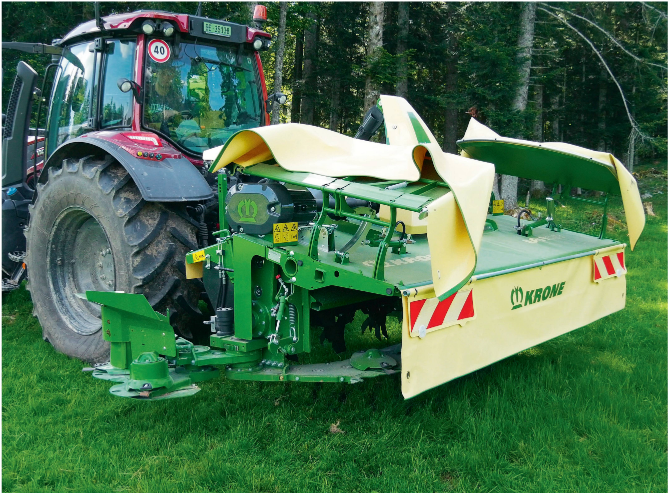
Die beiden äusseren Mäheinheiten können für die Strassenfahrt hydraulisch nach hinten geschwenkt werden. Nach oben geklappt werden die Seitenschutzte. Bilder: H. Röthlisberger
