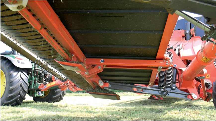
Vier Gleitkufen sind für die Bodenanpassung und die Arbeitshöhe verantwortlich.
