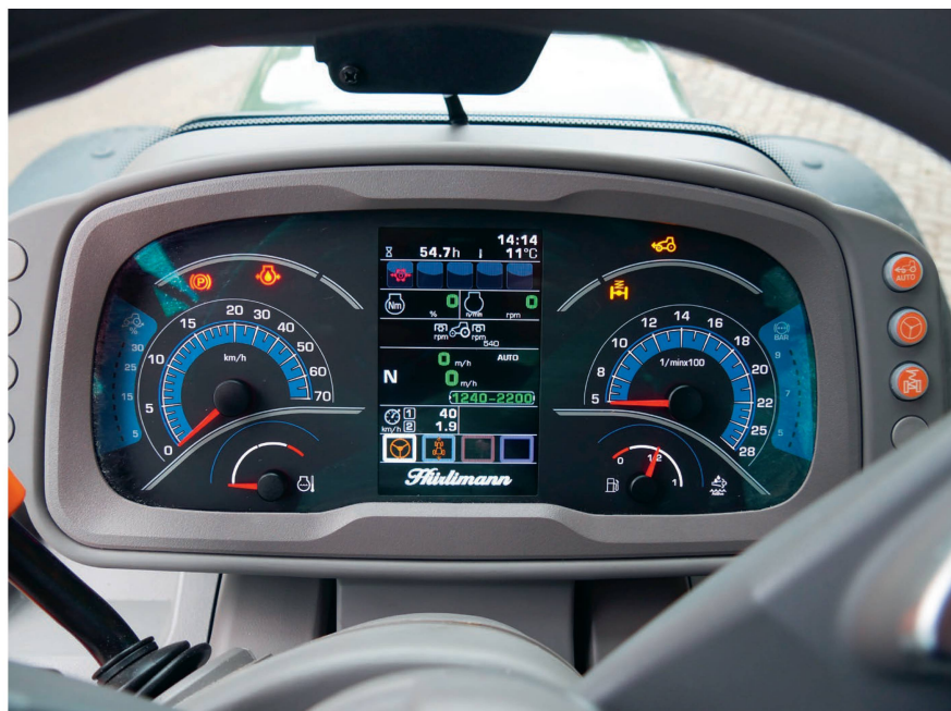
Das mittige, 5 Zoll grosse «InfoCenterPro» informiert über sämtliche Betriebszustände des Traktors und dient auch für verschiedene Einstellungen.
