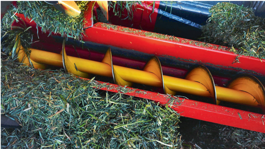
Futterverluste werden von einem Kratzboden gesammelt und anschliessend über zwei Schnecken zum Aufnahmeband zurückgeführt.
