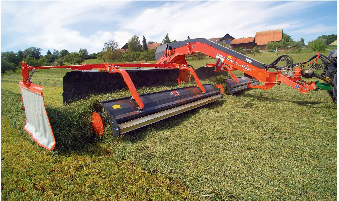
Die Bandschwader von Kuhn sind mit einer Kombination von Rollenniederhalter und gewölbtem Führungsblech ausgerüstet, das Verluste vermeiden und für einen optimalen Gutfluss sorgen soll. Bilder: R. Engeler
