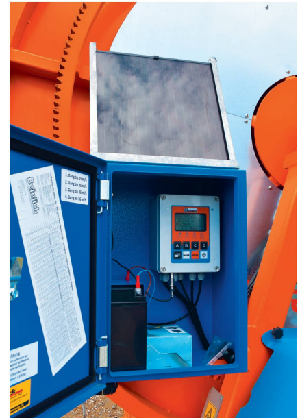
Alle Elektronik-Funktionen sind mit oder ohne Handy möglich, die Elektronik korrespondiert mit dem «Raindancer».
