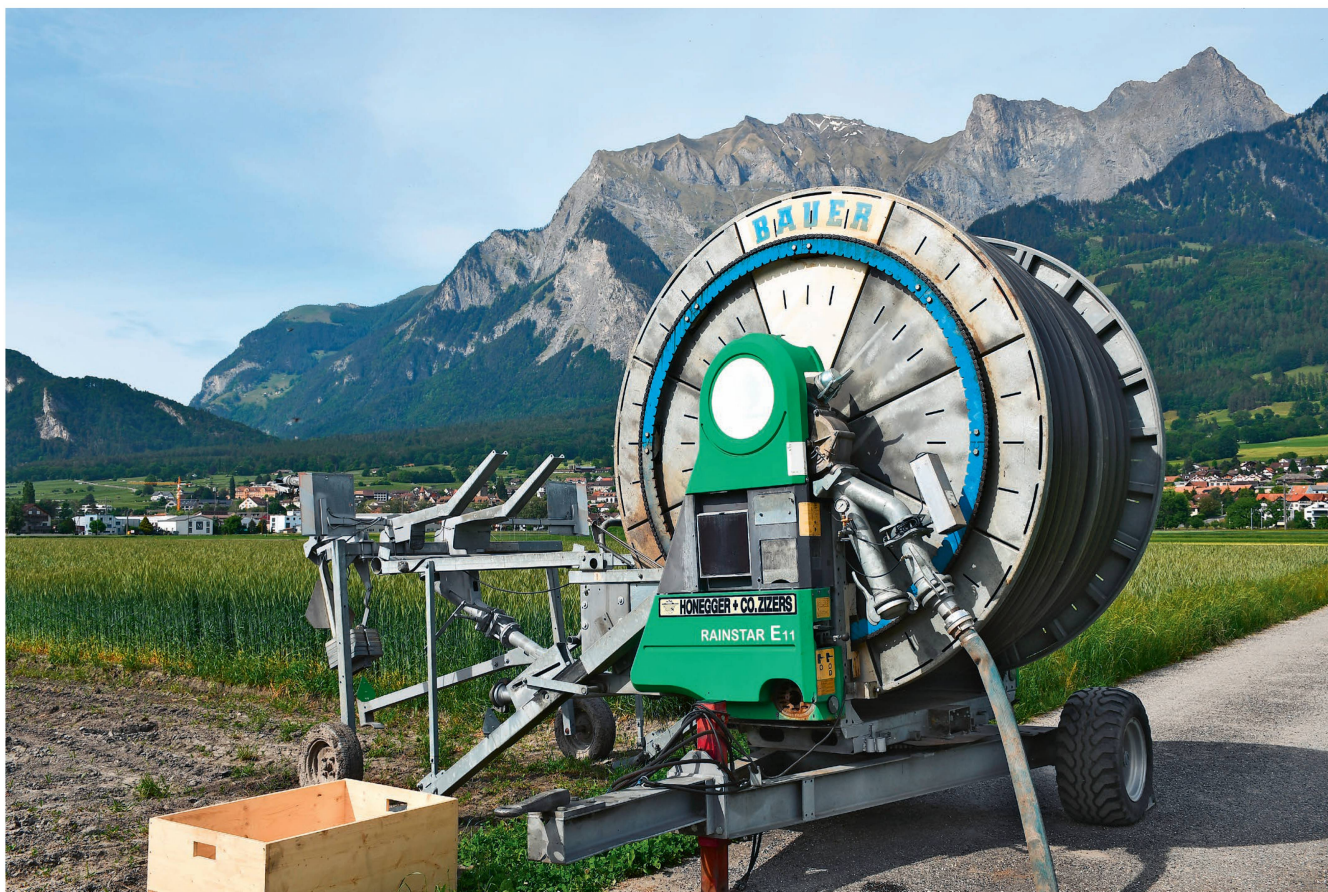
Die Bewässerungsmaschine mit Starkregner ist die verbreitetste Technik. Bild: R. Hunger
