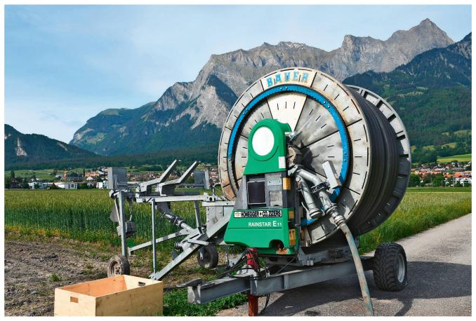
Die Bewässerungsmaschine mit Starkregner ist die verbreiteteste Technik. Bild: R. Hunger
