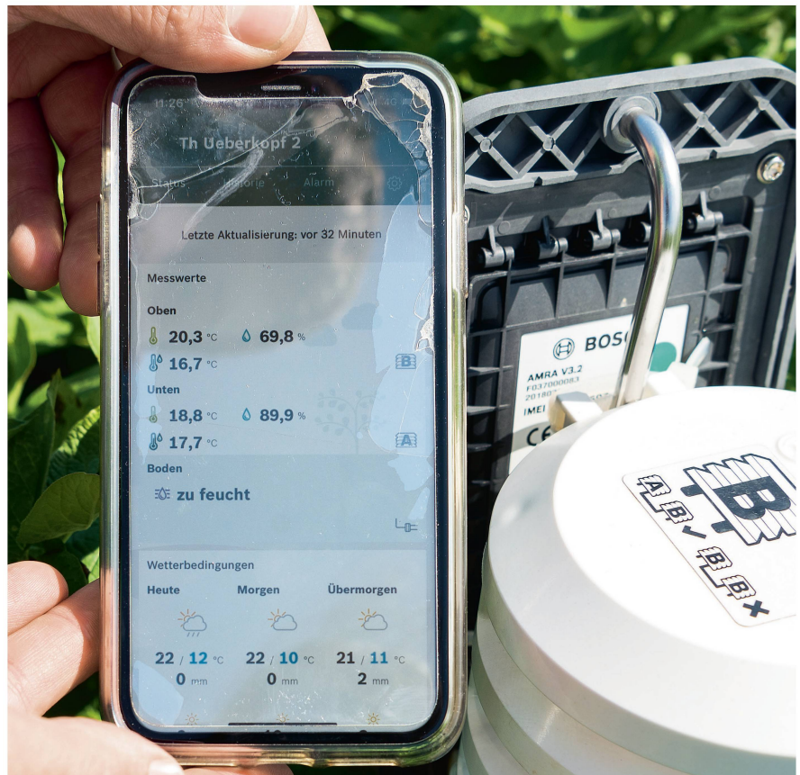
Anzeige von Boden- und Luftfeuchtigkeit sowie der Lufttemperatur auf dem Smartphone mittels der App zur Feldüberwachung «Deepfield Connect».
