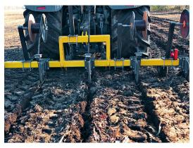
Das tiefere Einbringen der Rohre für die Tropfbewässerung, etwa bei mehrjährigen Kulturen, erfolgt mit dem Verlegepflug, hier in der fünfreihigen Ausführung.
