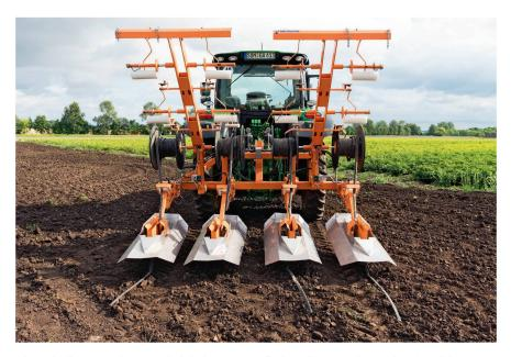
Die Technik zum Verlegen und Einholen der Tropfrohre gibt es in vier- und sechsreihiger Ausführung. Die Verlegescharen sind beweglich und passen sich Abweichungen in der Reihenweite an.
