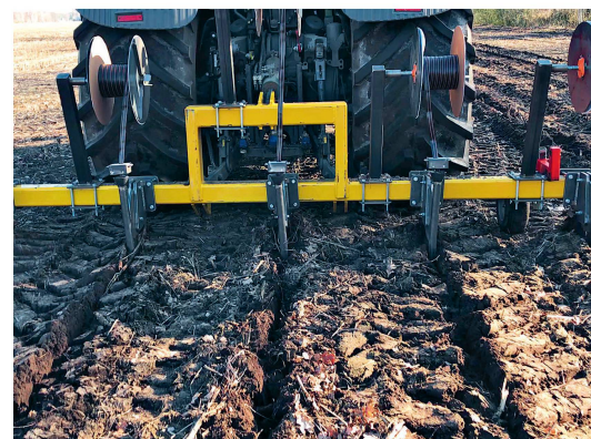
Das tiefere Einbringen der Rohre für die Tropfbewässerung, etwa bei mehrjährigen Kulturen, erfolgt mit dem Verlegepflug, hier in der fünfreihigen Ausführung.
