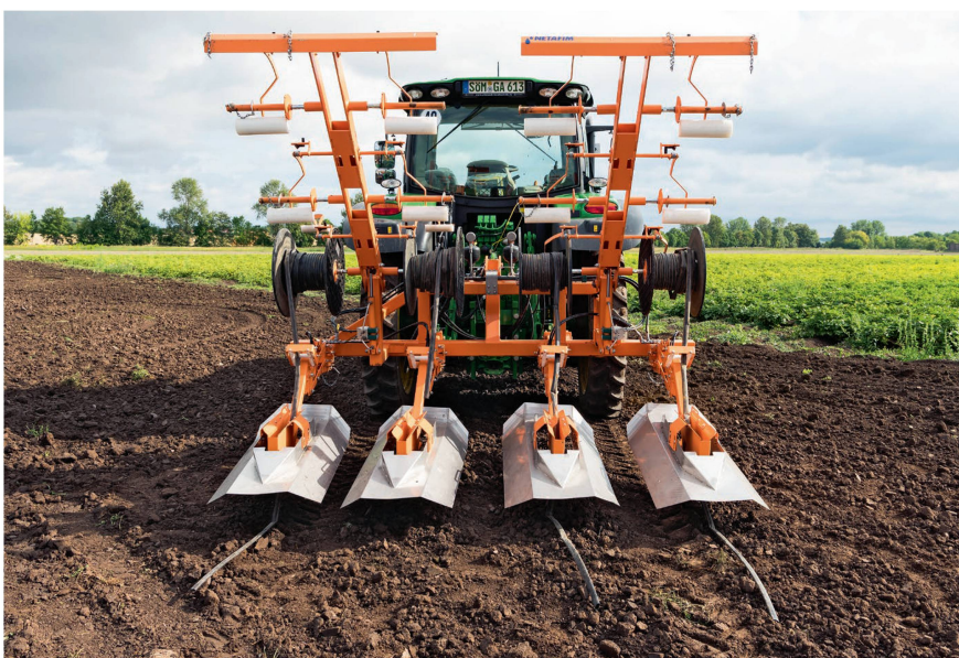
Die Technik zum Verlegen und Einholen der Tropfrohre gibt es in vier- und sechsreihiger Ausführung. Die Verlegescharen sind beweglich und passen sich Abweichungen in der Reihenweite an.
