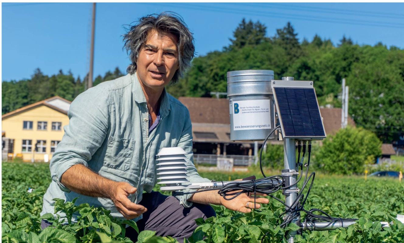
Andreas Keiser, Dozent für Ackerbau und Pflanzenzüchtung an der HAFL in Zollikofen, mit einer Bodensonde von bewaesserungsnetz.ch. Die Messungen der Sonden helfen, den optimalen Bewässerungszeitpunkt und die passende Bewässerungsmenge festzulegen. Bilder: R. Burkhalter
