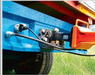
Die Kugelkopf-Kupplung bringt an Anhängern auch als hintere Kupplung Vorteile.
