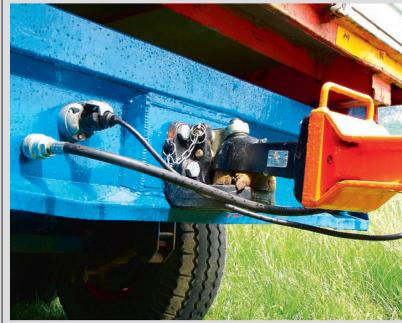
Die Kugelkopf-Kupplung bringt an Anhängern auch als hintere Kupplung Vorteile.
