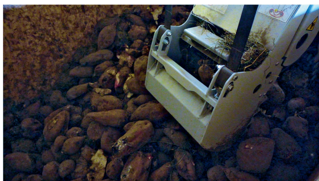
Der Greifer kommt mit ganzen Futterrüben problemlos zurecht. Diese werden zerkleinert und sind auf der ganzen Länge erstaunlich gut verteilt.
