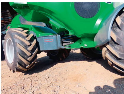
Stand sicher: Dank starrem Knickgelenk gibt es bei Bodenunebenheiten keine Verwindung zwischen Vorder- und Hinterwagen.
