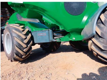
Standstabil: Dank starrem Knickgelenk gibt es bei Bodenebenenheiten keine Verwindung zwischen Vorder- und Hinterwagen.
