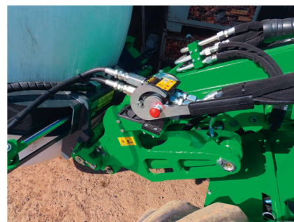
Die Schnellkuppler an den Anbaugeräten sind sauber gefertigt und haben sich im praktischen Einsatz bewährt.
