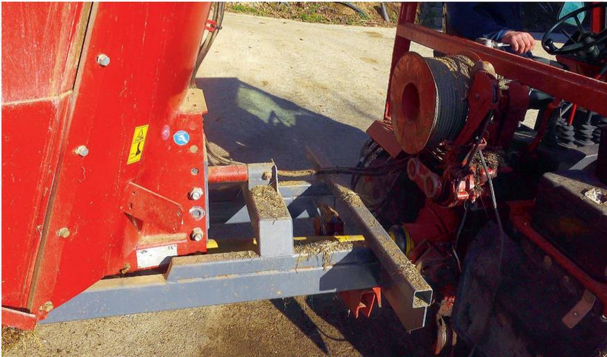
Der Aufbau mit Stahlrahmen kann wie ein herkömmliches Aufbaugerät in kurzer Zeit auf- und abgebaut werden.
