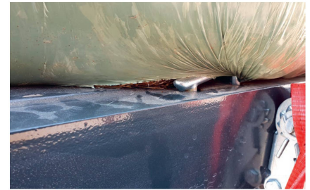
Die nicht ganz versenkten 2-t-Zurr-Ösen sind für die Zusatzsicherung praktisch, können aber die Folien der Ballen verletzen.
