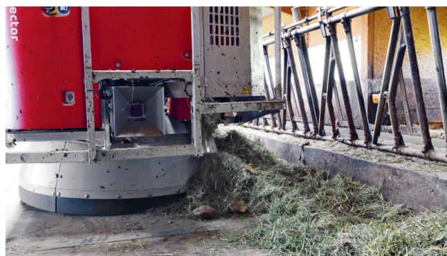
Der Greifer kommt mit ganzen Futterrüben problemlos zurecht. Diese werden zerkleinert und sind auf der ganzen Länge erstaunlich gut verteilt.
