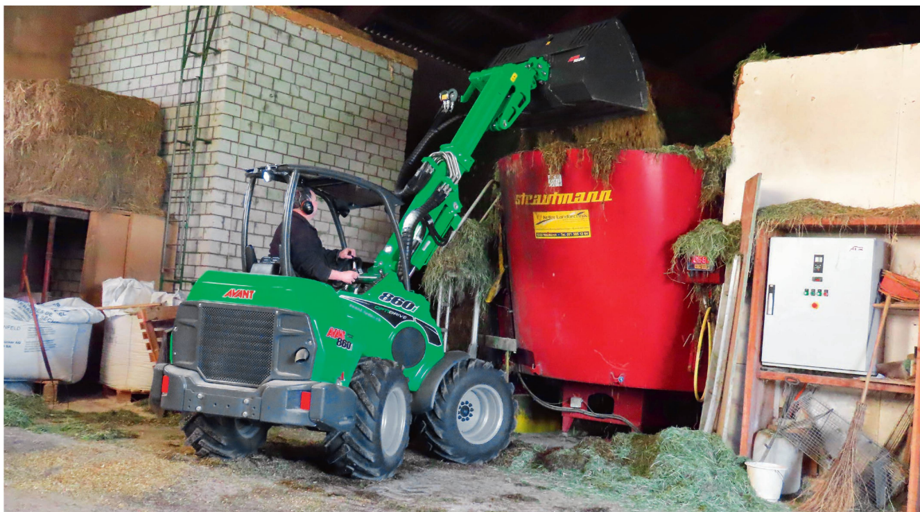
Mit dem Avant «860i» und dem teleskopierbaren Hubarm lassen sich auch hohe Behälter wie dieser stationäre Futtermischer gut beschicken.
