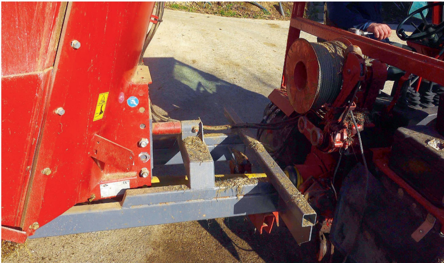
Der Aufbau mit Stahlrahmen kann wie ein herkömmliches Aufbaugerät in kurzer Zeit auf- und abgebaut werden.
