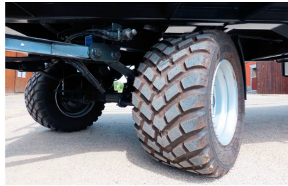
Eine robuste Drehschemel-Lenkung, gefeder- te Achsen und die 500er Bereifung machen auch Fahrten abseits der Strasse möglich.
