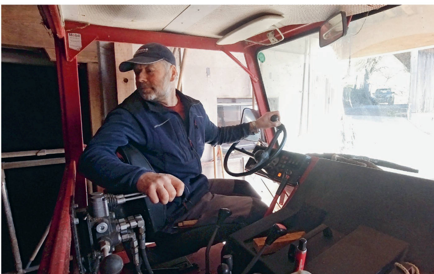
Peter Ramseier aus Linden BE bei der Arbeit. Für die Bedienung der beidseitigen Schieber wurde ein einfacher Steuerblock neben dem Fahrer installiert.
