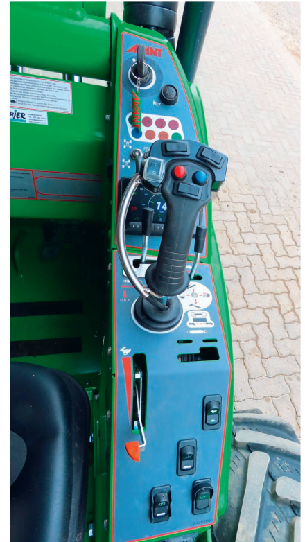
Rechts auf der Konsole sind alle Bedienelemente griffgünstig angeordnet. Das Display befindet sich etwas verdeckt hinter dem Joystick.
