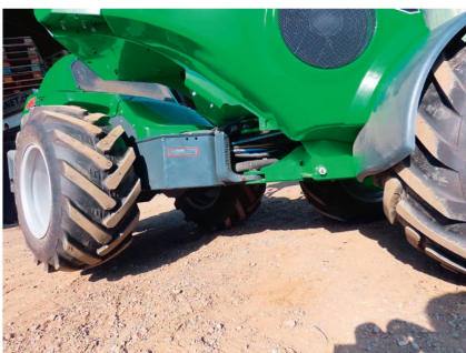
Standstabil: Dank starrem Knickgelenk gibt es bei Bodenebenheiten keine Verwindung zwischen Vorder- und Hinterwagen.
