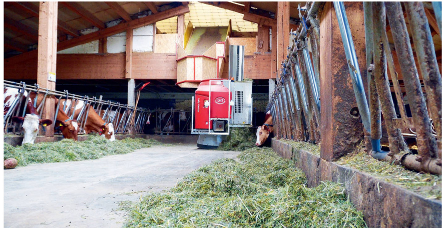
Der «Vector» ist ein komplett schienenfreies System und bietet so beispielweise zum Eingrasen jede Flexibilität.
