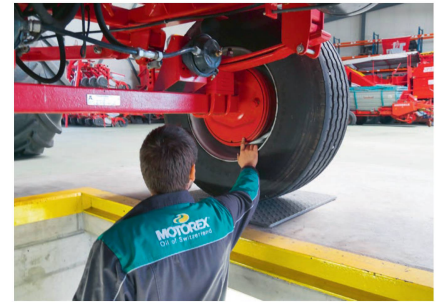
Mit der Rüttelplatte wird der Zustand des Fahrwerks kontrolliert und beispielsweise geschaut, ob die Räder Spiel haben.
