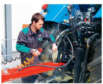
Anschluss der Bremsleitung: Der Kunde muss wissen, welche Abbremsung sein Anhänger erfüllen muss. Sind es 38 Prozent oder 50 Prozent (seit 1. Mai 2019) Abbremsung des Gesamtgewichts?
