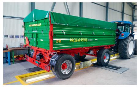
Die Bremsprüfung mit dem Rollen-Prüfstand liefert genaue Daten und findet immer bei den gleichen Bedingungen statt.
