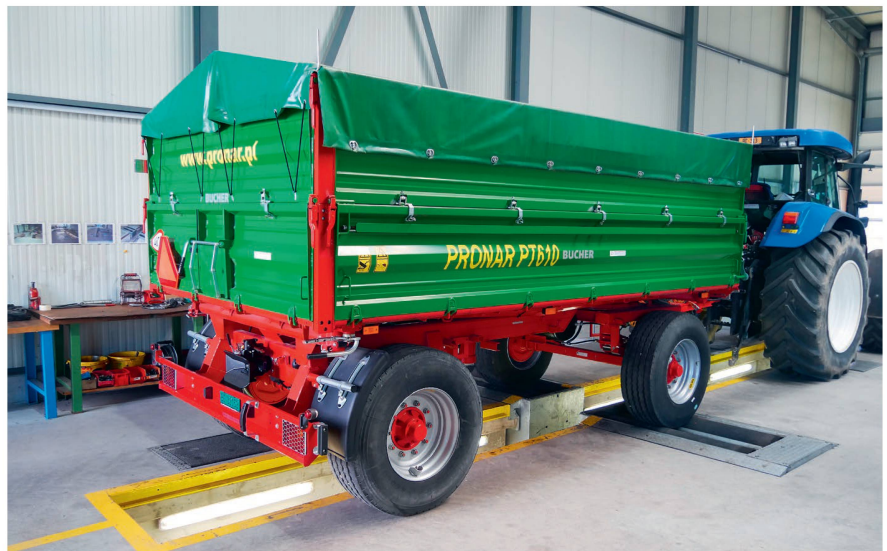
Die Bremsprüfung mit dem Rollen-Prüfstand liefert genaue Daten und findet immer bei den gleichen Bedingungen statt.
