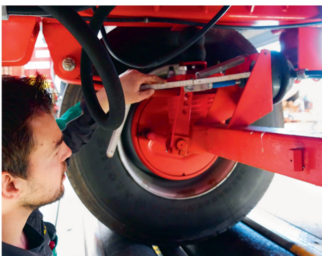
Stösst der Bremszylinder bei der Betätigung der Bremse zu weit hinaus, weist das auf verschlissene Bremsbeläge hin. Diese Messkontrolle kann man auch zu Hause selber regelmässig durchführen.
