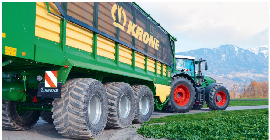
Gelenkt und gefedert: Das Tridemfahrwerk unter diesem Erntewagen lässt keine Wünsche offen. Bild: R. Hunger
