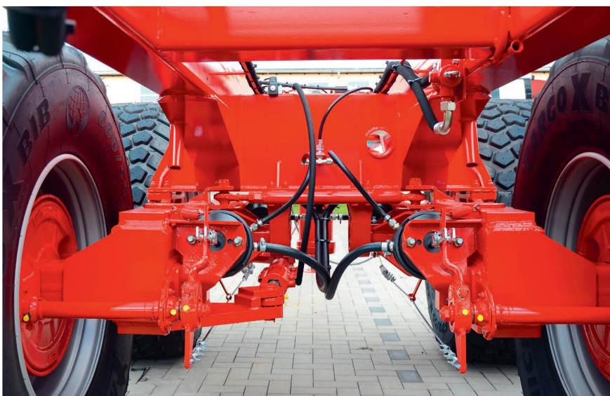
Pendelachsaggregat: Dieses Fahrwerk ermöglicht einen seitenunabhängigen Pendelausgleich. Bild: R. Hunger
