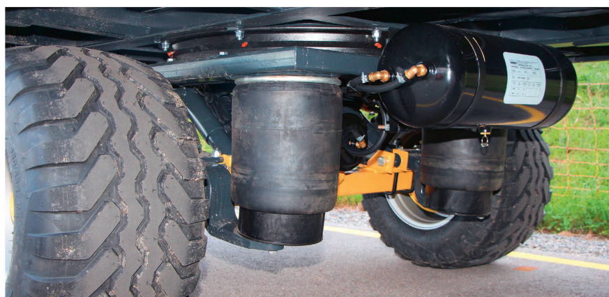
Viel Fahrkomfort: Ein Luftfedersystem benötigt aber eine Druckluftanlage. Bild: Kurmann
