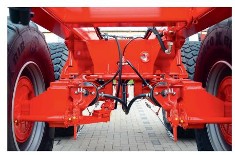
Pendelachsaggregat: Dieses Fahrwerk ermöglicht einen seitenunabhängigen Pendelausgleich. Bild: R. Hunger
