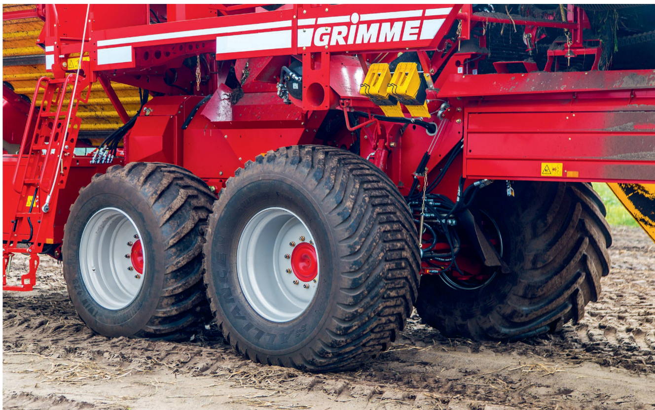
Angetrieben: Der Kartoffelroder Grimme «Evo 290» ist optional mit einem Radnabenmotor lieferbar. Bild: Grimme
