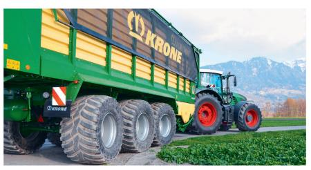
Gelenkt und gefedert: Das Tridemfahrwerk unter diesem Erntewagen lässt keine Wünsche offen. Bild: R. Hunger
