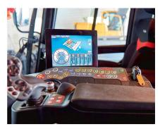
Das von Kässbohrer patentierte «iTerminal» mit 10-Zoll-Display.
