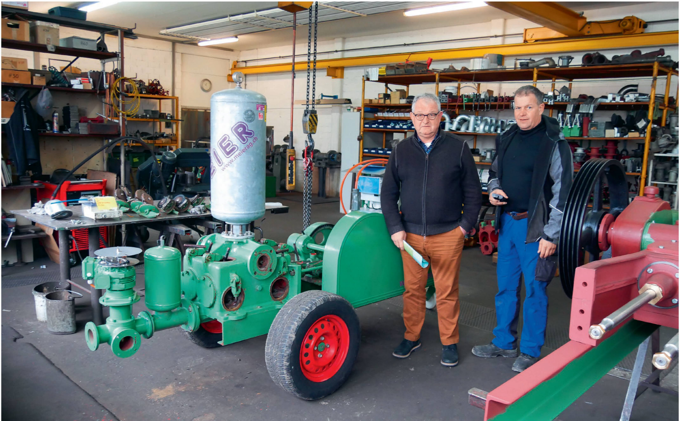
Hans Peter und Erich Meier sind bei der Hans Meier AG für die Gülletechnik zuständig. Diese Kolbenpumpe ist rund 60-jährig und steht für die Revision bereit. Bilder: H. Röthlisberger
