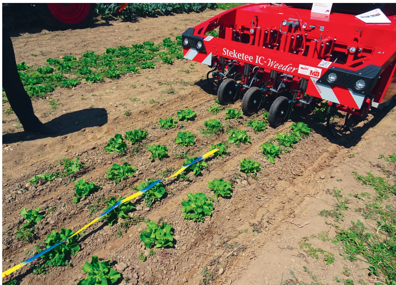
Der Steketee «IC-Weeder» hackt in der Reihe, die Ansteuerung der Hackmesser erfolgt pneumatisch. Das Gerät kann zusätzlich mit einem Spritztank zur punktgenauen Applikation von Pflanzenschutzmitteln ausgerüstet werden. Bild: R. Engeler
