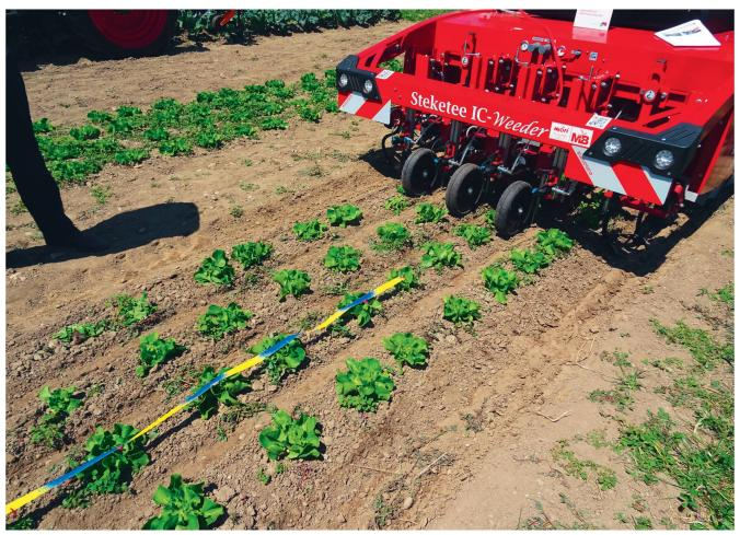
Der Steketee «IC-Weeder» hackt in der Reihe, die Ansteuerung der Hackmesser erfolgt pneumatisch. Das Gerät kann zusätzlich mit einem Spritztank zur punktgenauen Applikation von Pflanzenschutzmitteln ausgerüstet werden. Bild: R. Engeler
