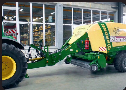
Die Montage über Steckbolzen lässt sich in rund 15 Minuten realisieren.
