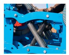
Das spezielle «Monoshox»-Dämpfungssystem von Monosem mit zwei Federn und einem Stossdämpfer.
