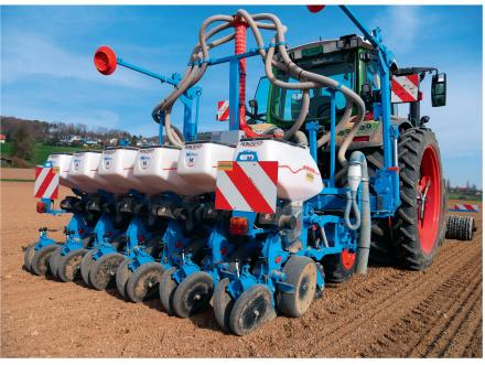
Die Einzelkornsämaschine «Monoshox NG Plus ME Extend» bei der Zuckerrüben-Saat mit einer Geschwindigkeit von 7 km/h. Bilder: R. Engeler
