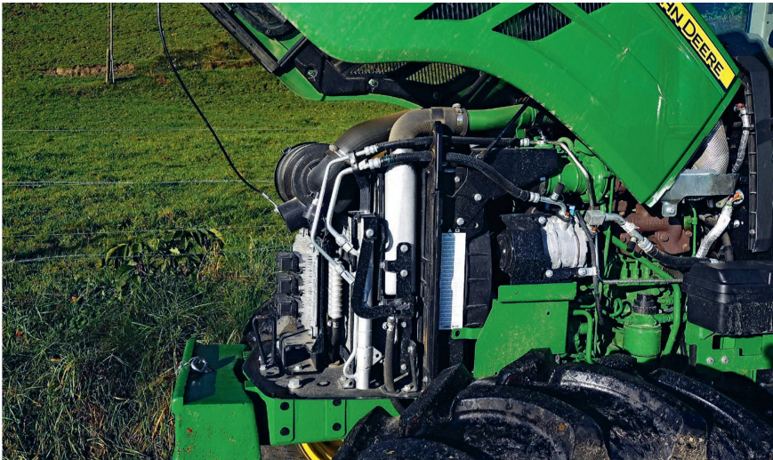
Für die Wartung ist der Motor gut zugänglich, jedoch lassen sich die Kühler für die Reinigung nicht ausklappen.
