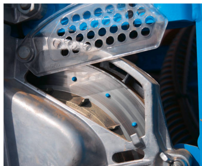
Seitlich der Säscheibe kann man die Zellenbelegung durch das hochklappbare Plexiglasfenster kontrollieren.
