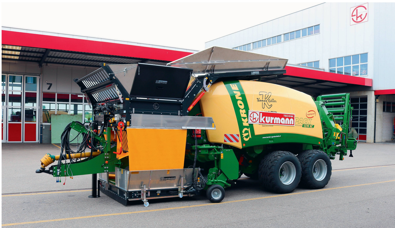
Das Dosiergerät «QB Modell 19» bietet dank klappbarer Rutsche eine sehr grosse Aufgabefläche. Bilder: R. Burkhalter / Kurmann
