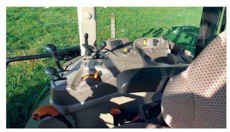
Die Bedienungselemente sind in der Seitenkonsole praktisch angeordnet.
