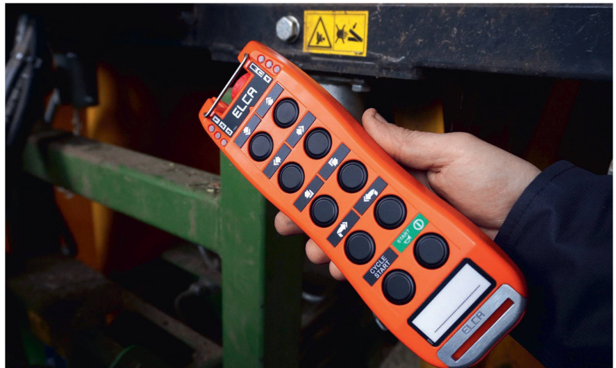
Die hydraulischen Funktionen lassen sich entweder über die Steuergeräte des Traktors oder über die hier abgebildete Funkfernsteuerung mit Drucktasten bedienen.
