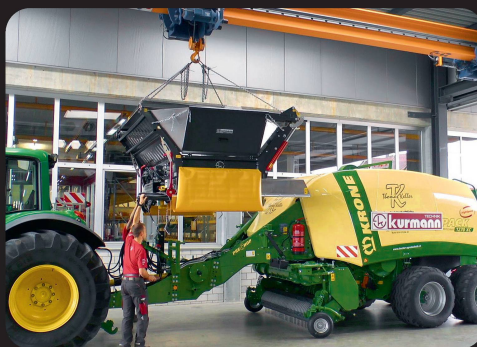
Die Montage über Steckbolzen lässt sich in rund 15 Minuten realisieren.
