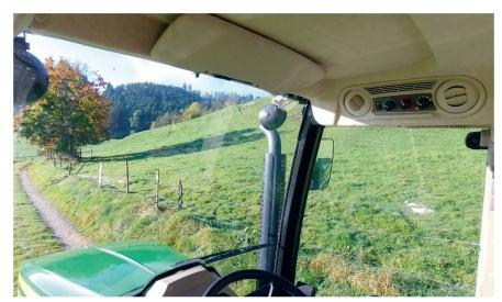
Die hoch in den Dachhimmel gezogene Frontscheibe ermöglicht eine sehr gute Sicht und einen hellen Arbeitsplatz.
