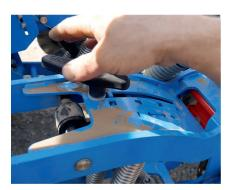
Der Schardruck lässt sich über einen Hebel einfach verstellen. Bis 240 kg sollen möglich sein.
