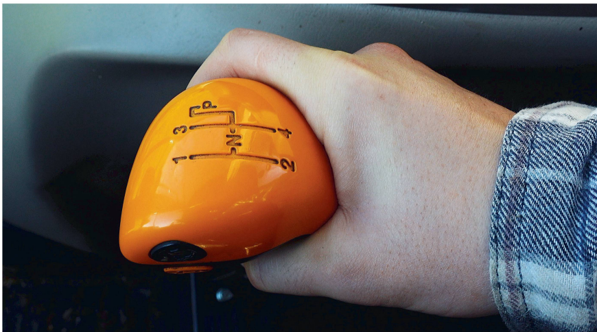
Die Parksperre ist am Hauptschalthebel rechts vom dritten Gang angeordnet.
