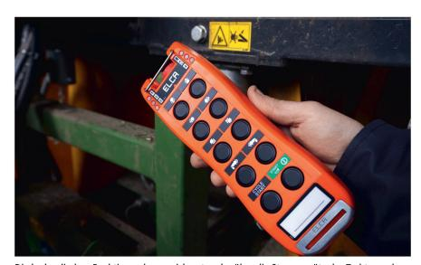
Die hydraulischen Funktionen lassen sich entweder über die Steuergeräte des Traktors oder über die hier abgebildete Funkfernsteuerung mit Drucktasten bedienen.
