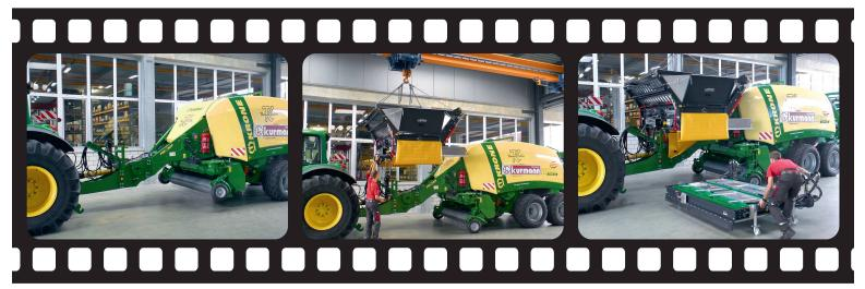
Die Montage über Steckbolzen lässt sich in rund 15 Minuten realisieren.
