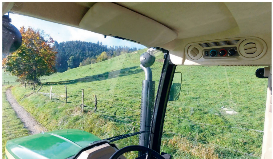
Die hoch in den Dachhimmel gezogene Frontscheibe ermöglicht eine sehr gute Sicht und einen hellen Arbeitsplatz.
