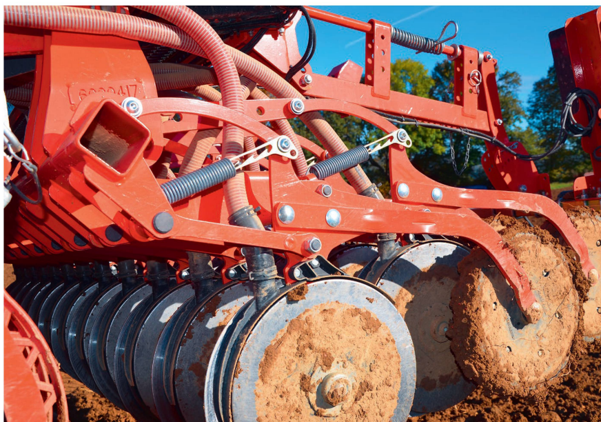
Ein- oder Doppelscheibenschar? Wichtiger als die Hersteller-Philosophie ist der Einfluss des Bodens. Bild: R. Hunger
