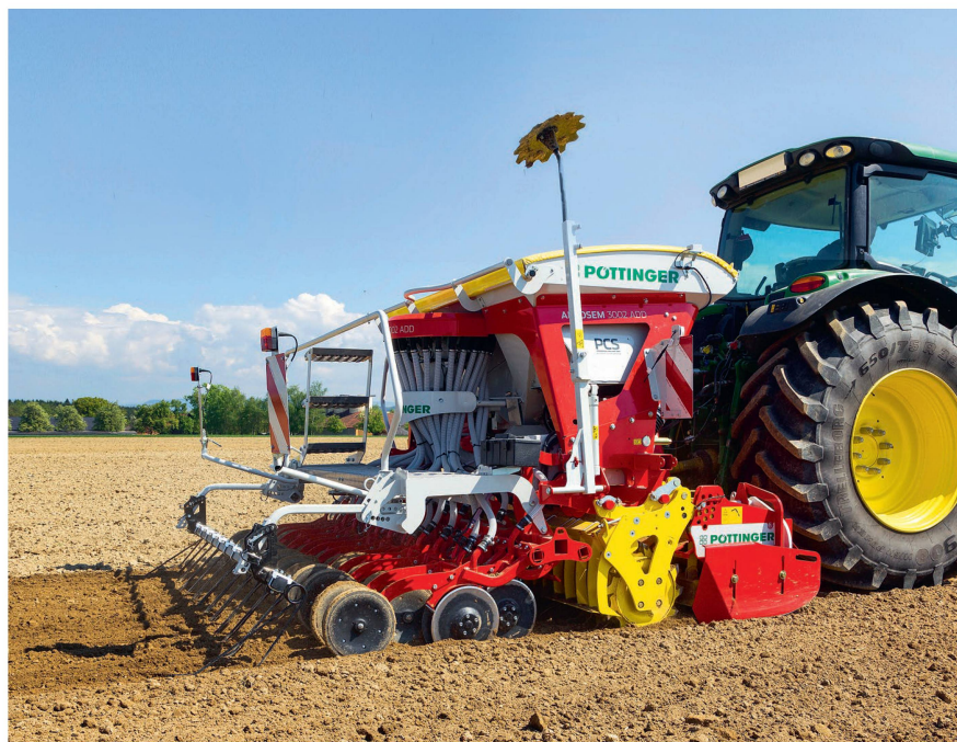
Ein oder mehrere Verteilköpfe? Das Platzangebot und die Länge der Transportschläuche entscheiden. Bild: Pöttinger
