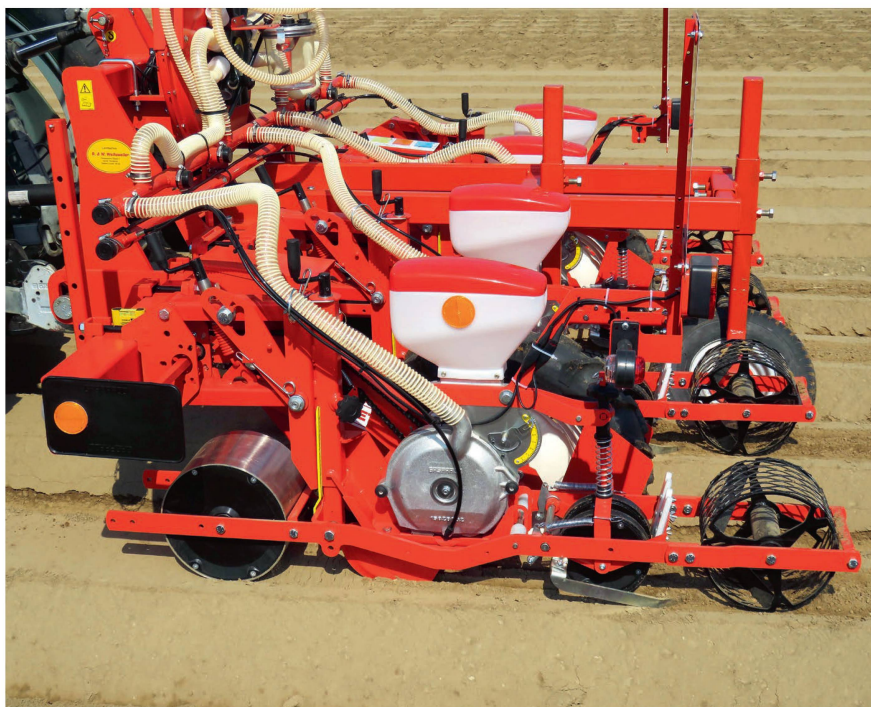
Das parallelogrammgeführte Säaggregat ist speziell auf die sensible Gemüsesamen-Aussaat ausgelegt. Bild: Gaspardo/Maschio
