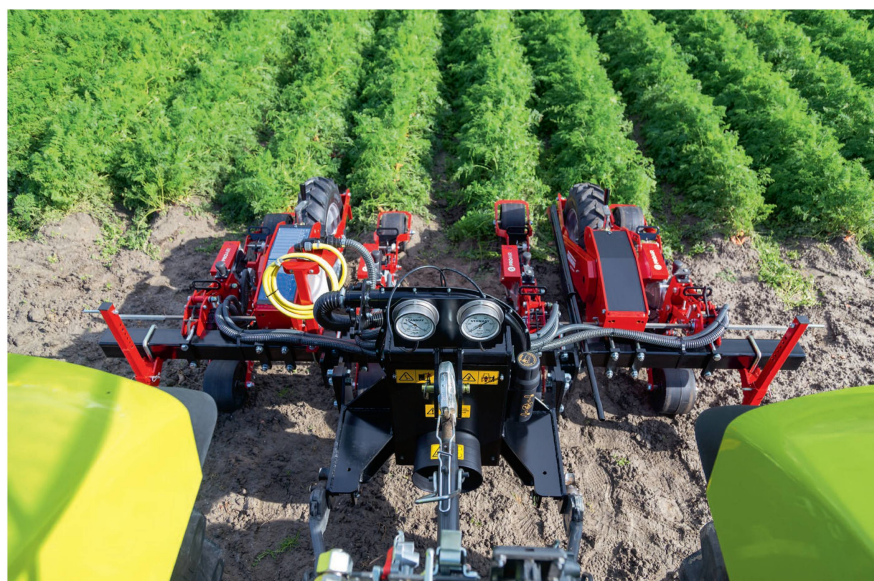
Die klassische Gemüse-Einzelkornsämaschinen ist mit ihrer Arbeitsbreite auf den Zwischenradbereich des Traktors ausgelegt. Bild: Stanhay
