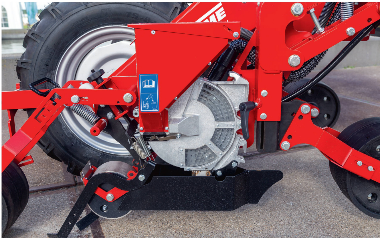
Dieses Aggregat kann Samen von 1 bis 10 mm Durchmesser exakt in bis zu vier Linien säen. Bild: Grimme
