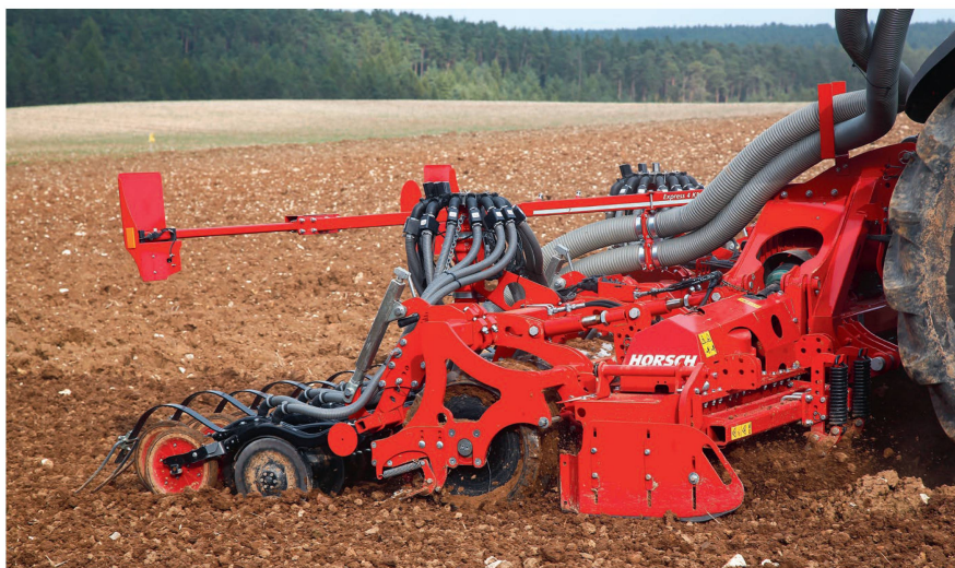
Mit einer gleichmässigeren Flächenverteilung des Saatguts sollen jeder Einzelpflanze gleiche Ressourcen zur Verfügung gestellt werden (Beispiel Einzelkorn-Saat bei Getreide mit dem «Singular System» von Horsch). Bild: Horsch
