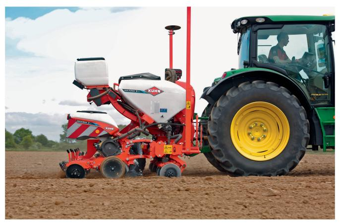
Nicht nur das Saatgut, sondern auch mineralische Dünger werden zunehmend direkt in den Boden eingebracht – und zwar zeitgleich mit der Aussaat. (Kuhn «Maxima» mit Düngerausrüstung). Bild: Kuhn
