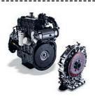
Reihe geschaltete Zylinder liefert der Verbrennungsmotor eine maximale Leistung von 74 PS, während der Elektromotor mit einer Dauerleistung von 27 PS und einer Spitzenleistung von 40 PS aufwarten kann.
