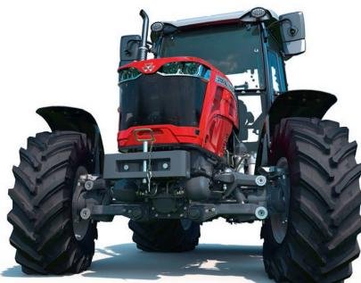
Die neue Vorderachsgefördert, die Massey Ferguson bei den Traktoren der Baureihe «MF 3700 AL» als Option einföhrt, ist ab sofort bestellbar, soll den Fahrkomfort, die Traktion und das Handling der Traktoren weiter verbessern. Die geförderte Vorderachse ist für alle Modelle mit 75, 85 und 95 PS, mit Standard- und Niedrig-
