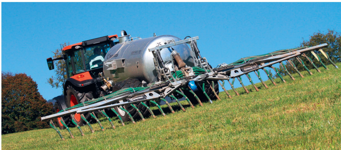
Ab 2022 wird die emissionsarme Ausbringtechnik bis 18% Hangneigung obligatorisch. Bilder: zvg
