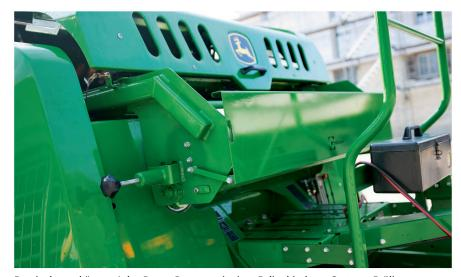
Bereits heute können John-Deere-Pressen mit einer Folienbindung, System «Brülisauer», ausgerüstet werden. Bild: Brülisauei
