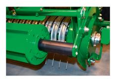
Das Zuführsystem mit Rollenniederhalter und gesteuerten Pickup-Zinken verkraftet auch grosse Schwaden. Bild: R. Hunger
