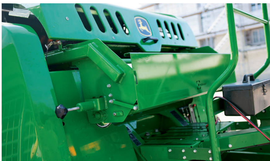
Bereits heute können John-Deere-Pressen mit einer Folienbindung, System «Brülisauer», ausgerüstet werden. Bild: Brülisauer
