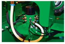
Angetriebene Schmierung nach dem volumetrischen System.
