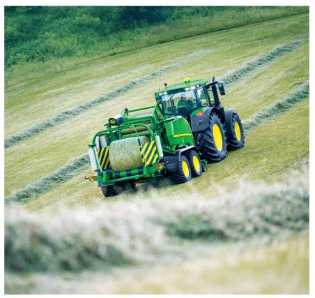
Die Presse «C441R» im Einsatz als Press-Wickel-Kombination. Bild: John Deere
