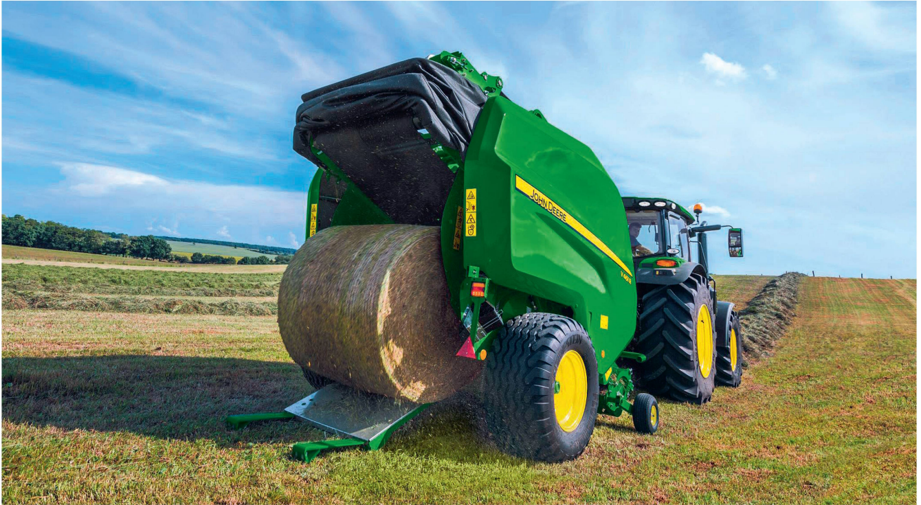
In weniger als fünf Sekunden wird der Ballen bei der «V461R» ausgeworfen und der Vorhang wieder geschlossen. Bilder: John Deere
