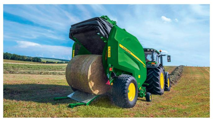
In weniger als fünf Sekunden wird der Ballen bei der «V461R» ausgeworfen und der Vorhang wieder geschlossen. Bilder: John Deere
