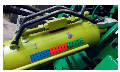
Der gebogene Haltebügel dient zusätzlich als Schutz für die Hohlschraube und den Sperrblock auf dem Zylinder.
