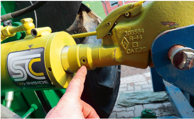
Der Oberlenker wird werkseitig mit einem Druck von 60 bar ausgeliefert. Sollte dieser Druck nicht zu den Anbaugeräten passen, kann er von einer autorisierten Fachwerkstatt verstellt werden.
