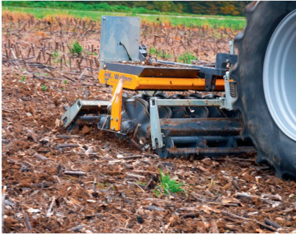
Bei der Vierfach-Walze «Double Cutting Master» kann an den Messerwalzen über eine Feder manuell eine Vorspannung und so der Auflagedruck eingestellt werden.
