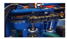
Die Schwenkbewegung wird durch eine robuste, umlaufende Kette erzeugt.
