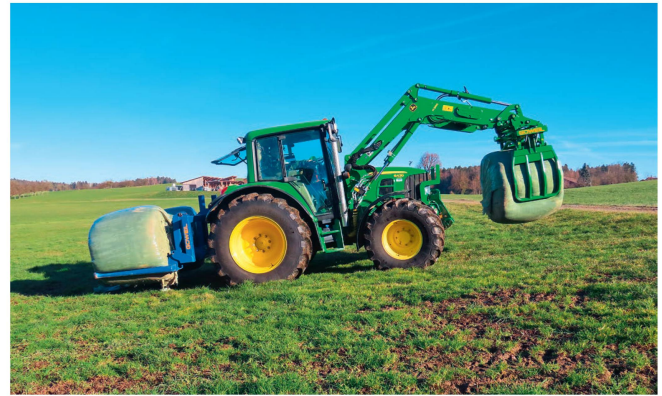
Im Praxistest wurde der Oberlenker beim Transport von Siloballen eingesetzt. Der Traktor war mit rund 900 kg schweren Siloballen (hinten zwei und vorne eine) beladen.
