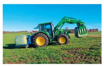
Im Praxistest wurde der Oberlenker beim Transport von Siloballen eingesetzt. Der Traktor war mit rund 900 kg schweren Siloballen (hinten zwei und vorne eine) beladen.
