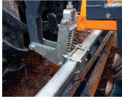
Bei der Vierfach-Walze «Double Cutting Master» kann an den Messerwalzen über eine Feder manuell eine Vorspannung und so der Auflagedruck eingestellt werden.
