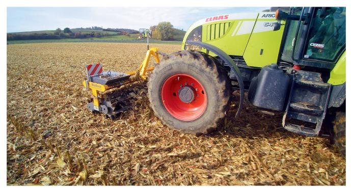
Die am Fronthubwerk angebaute Tandemmesserwalze – hier beschwert mit zwei 260-kg-Gewichten, vorne mit glatten und hinten mit gezackten Messern bestückt – leistete auf diesem Körnermais-Feld eine gute Arbeit. Bilder: R. Engeler
