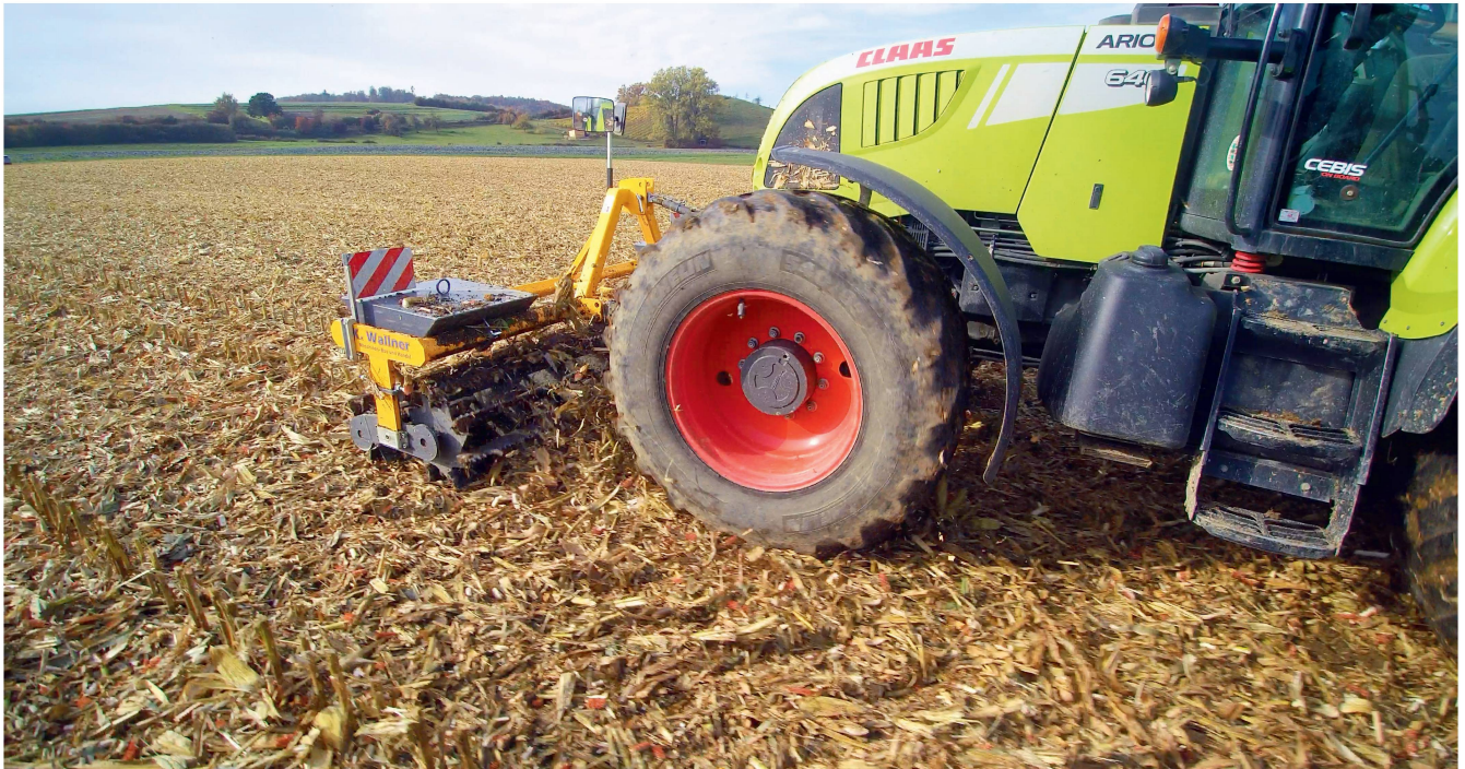
Die am Fronthubwerk angebaute Tandemmesserwalze – hier beschwert mit zwei 260-kg-Gewichten, vorne mit glatten und hinten mit gezackten Messern bestückt – leistete auf diesem Körnermais-Feld eine gute Arbeit. Bilder: R. Engeler
