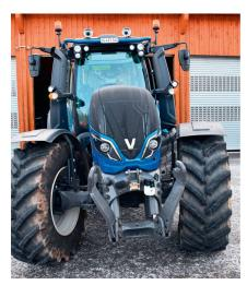
Die Vorderachse ist luftgefedert, hat Lamellenbremsen im Endantrieb und kann jederzeit Gewicht aufnehmen, damit das Adhäsionsgewicht stimmt.
