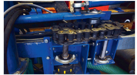
Die Schwenkbewegung wird durch eine robuste, umlaufende Kette erzeugt.
