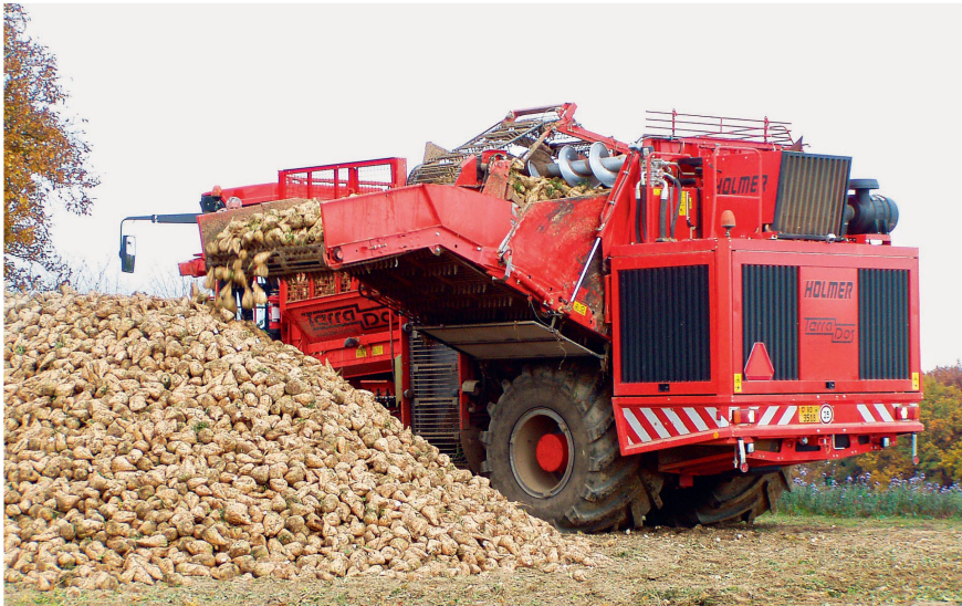
Grosse Erntemaschinen warnen beim Rückwärtsfahren die Umgebung mittels «Pieper» (dauernd) oder «Zischer» (situativ). Bild: R. Hunger
