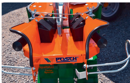
Schutzvorrichtungen reduzieren beim kleinen Senkrechtspalter das Unfallrisiko.
