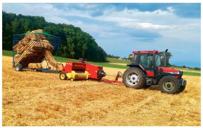
Der Case IH «4230» mit der «570»-Kleinballenpresse von New Holland und Eigenbau-Ballenanhänger. Bis zu 70 Ballen können geladen werden. Bilder: zVa / D. Senn
