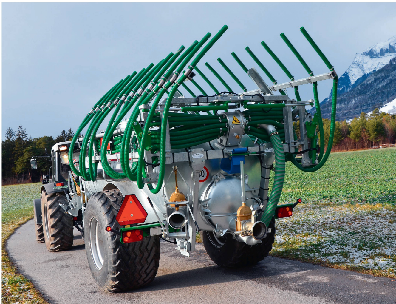
Neue Verteiltechnik am Güllefass reduziert die Verschmutzung der Heckleuchten. Bilder: R. Hunger
