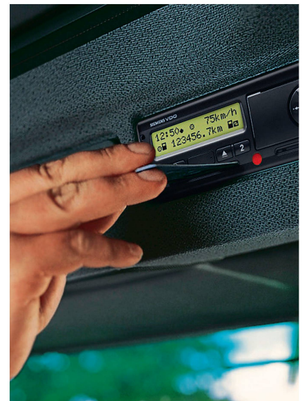
Traktoren mit Höchstgeschwindigkeit über 40 km/h müssen zusätzlich mit einem digitalen Fahrtenschreiber ausgerüstet sein.
