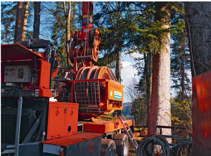
Die Seiltrommeln an der Kopfstation mit der gegenläufigen Aufspulung von Zug- und Rückführseil. Bild: R. Engeler
