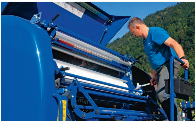
Ein «Göweil-Highlight»: Mit der Doppelbindung für Netz oder Mantelfolie lassen sich die Bindezeiten halbieren.
