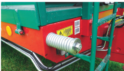
Der Spannungszustand des Kratzbodens lässt sich an den aussenliegenden Druckfedern jederzeit einfach bestimmen.
