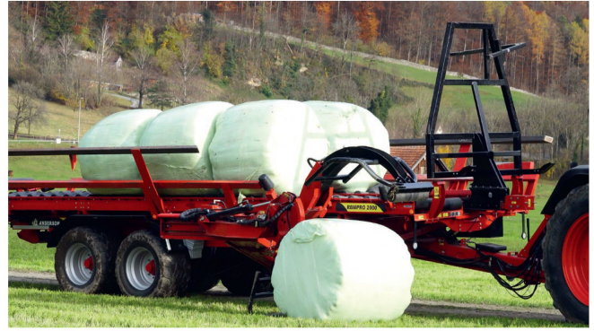
Je nachdem, wie tief die Ladefläche beim Entladevorgang hinten abgesenkt wird, werden die Ballen stehend oder liegend abgelegt.
