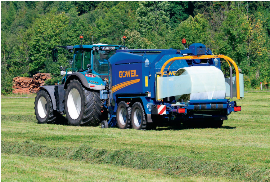
Die robust gebaute Press-Wickel-Kombination «G1 F125» von Göweil zeichnet sich durch eine hohe Durchsatzleistung und einen enorm hohen Pressdruck aus. Damit lassen sich musterhafte Ballen machen. Bilder: J. Paar
