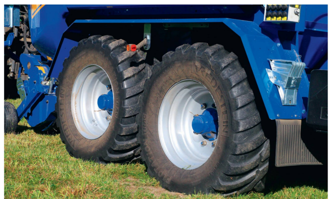
Die Press-Wickel-Kombination ist serienmässig mit «Flotation Trac»-Reifen von Vredestein der Dimension «560/45-R22.5» bestückt.
