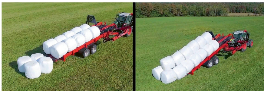
Möglich sind zwei Ablagevarianten: die Ablage der Ballen auf die geschützte Stirnseite bei der Zwei-Reihen-Beladung (links). Bei der zweiten Variante werden die Ballenreihen liegend abgelegt. Diese funktioniert auch bei der Drei-Reihen-Beladung.
