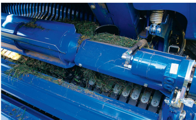
Die Zuführwalze mit Paddelblechen wird jetzt mechanisch angetrieben. Bei drohender Verstopfung schaltet sich ein Ölmotor zu.
