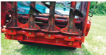
Der Ölstand der Winkelgetriebe lässt sich jederzeit an vier Schaugläsern ablesen.
