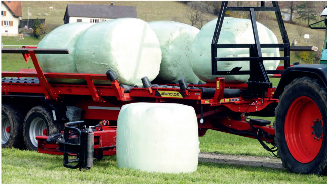
Dank Drehfunktion an der Zange ist die Aufnahme von stehenden und liegenden Ballen möglich.
