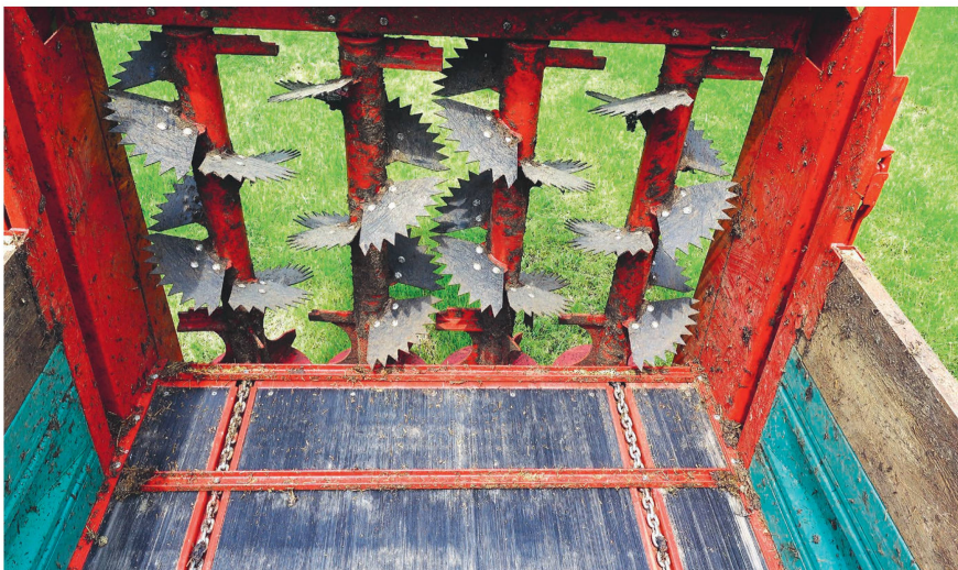
Die gezahnten Fräsmesser aus Hardox lassen sich durch die Schraubverbindung einfach ersetzen.
