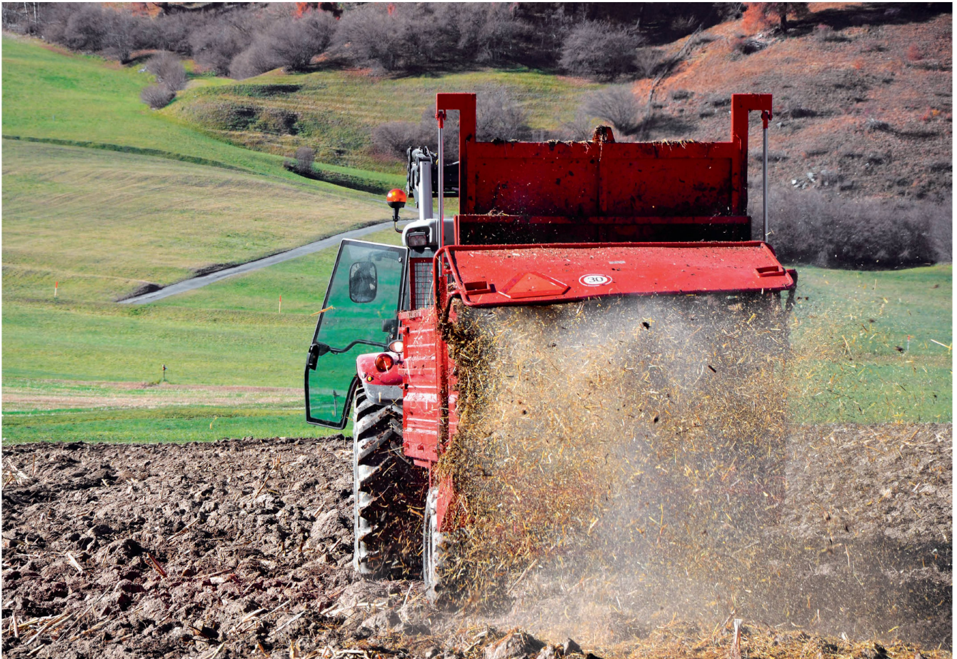
Rund zwei Drittel der erforderlichen Leistung eines durchschnittlichen Mistzettlers beansprucht das Streuwerk. Bild: R. Hunger
