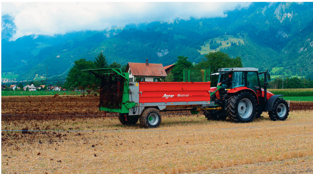
Der «Standardmistzetter» für die Eigenmechanisierung verfügt über vier stehende Streuwalzen. Bild: R. Hunger
