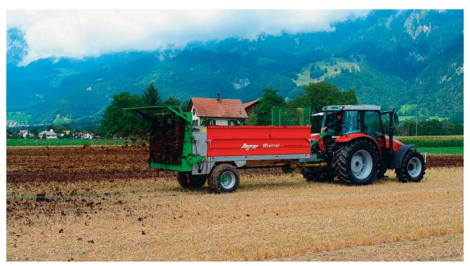
Der «Standardmistzetter» für die Eigenmechanisierung verfügt über vier stehende Streuwalzen. Bild: R. Hunger
