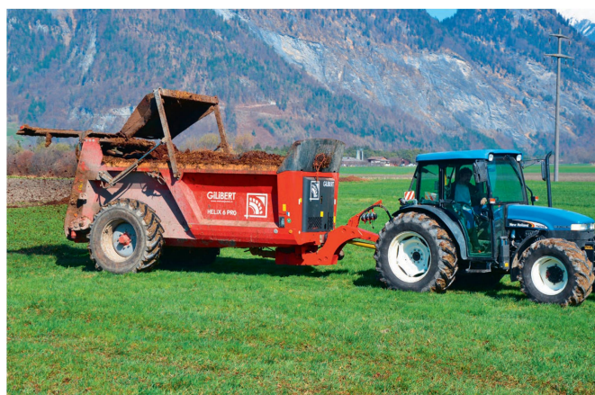
Muldenstreuer mit zwei stehenden Walzen und Stauschieber erfreuen sich zunehmender Beliebtheit. Bild: R. Hunger
