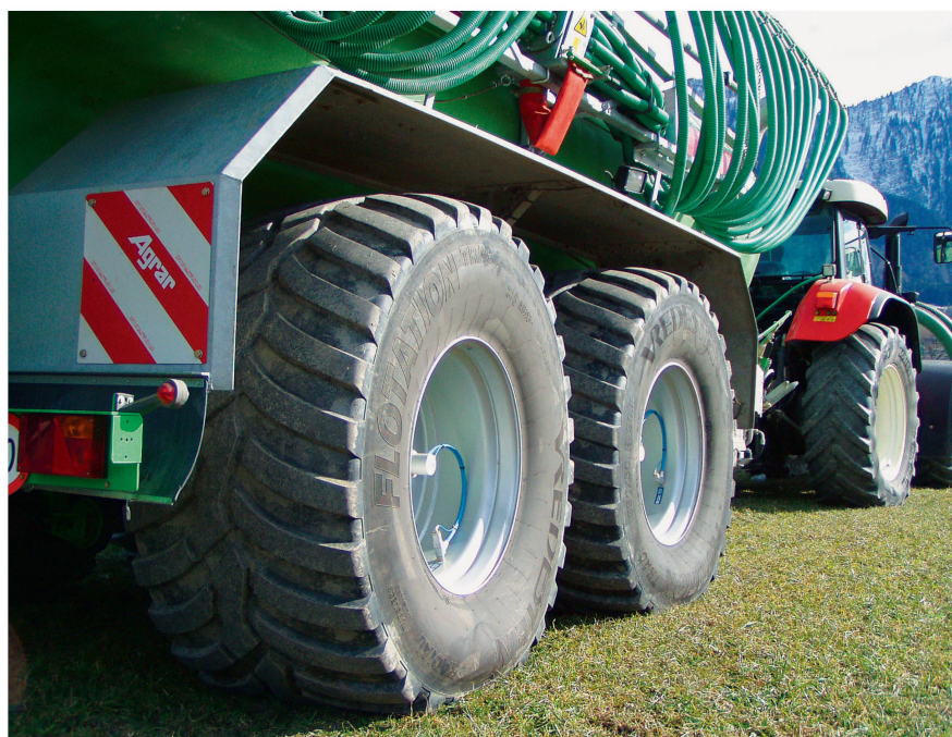
Grosse, breite Reifen mit einem Reifendruck-Reguliersystem sind derzeit das einzige Mittel, den Bodendruck zu minimieren.
