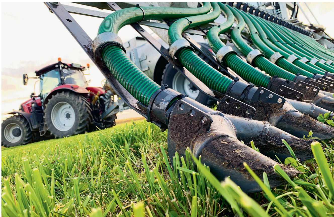
Die bodennahe Gülle-Applikation ist und bleibt die wirkungsvollste Minderungsmassnahme. Bild: Vogelsang
