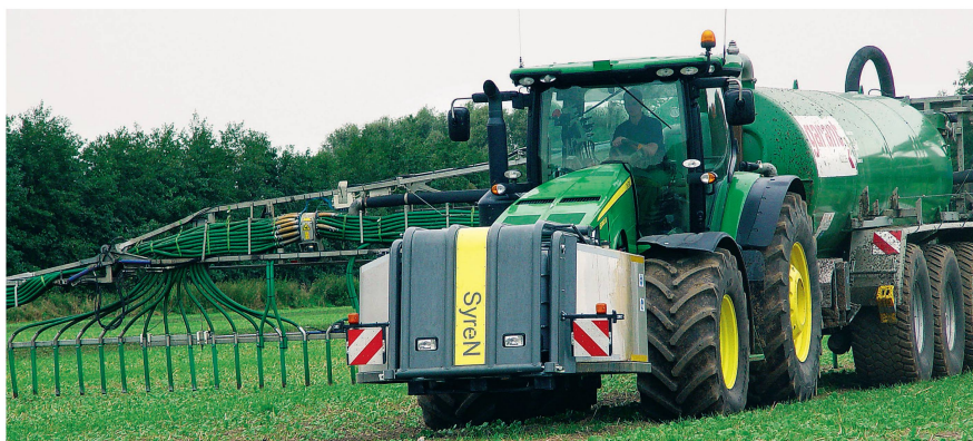
Das Ansäuern der Gülle reduziert die Ammoniakemissionen. Bild: SyreN
