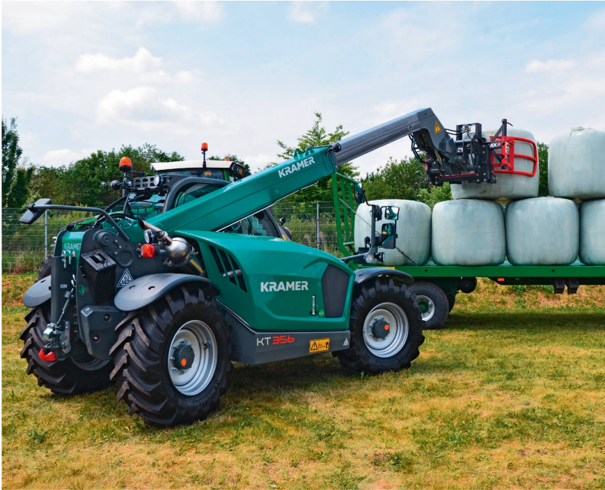
Die Gefahrenzonen beim Teleskoplader befinden sich seitlich/rechts und hinter dem Fahrzeug. Technische Hilfsmittel sind daher notwendig.
