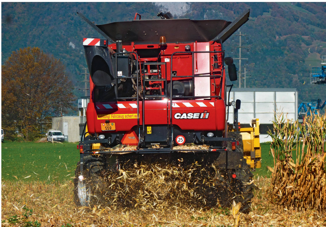
Beim Mähdrescher befinden sich die Gefahrenzonen rund um die Maschine. Zudem verfügt er über Hecklenkung und schwenkt aus. Daher müssen technische Hilfsmittel eingesetzt werden. Bilder: R. Hunger
