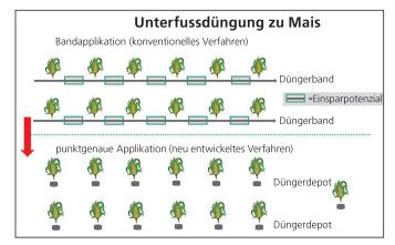
Bei der herkömmlichen Unterfussdüngung wird ein kontinuierliches Düngeband ausgebracht (oben), bei der punktgenauen Applikation erhält jedes Saatkorn synchron zur Ablage eine kleine Düngerportion.
