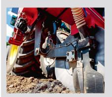
Parallel zu den pflanzenbaulichen Untersuchungen entwickelte das Forscherteam der TH Köln in Zusammenarbeit mit der Kverneland Group Soest GmbH eine neuartige Portioniereinheit für den Einsatz an einer herkömmlichen Einzelkornsämaschine. Diese Einheit, die zum Patent angemeldet ist, sei vielseitig für alle granulierten Düngerarten ausgelegt und könne somit auch auf viele Anwendungsbereiche der Einzelkornsaat übertragen werden, darunter Sojabohnen, Sonnenblumen, Ackerbohnen oder Zuckerrüben.
