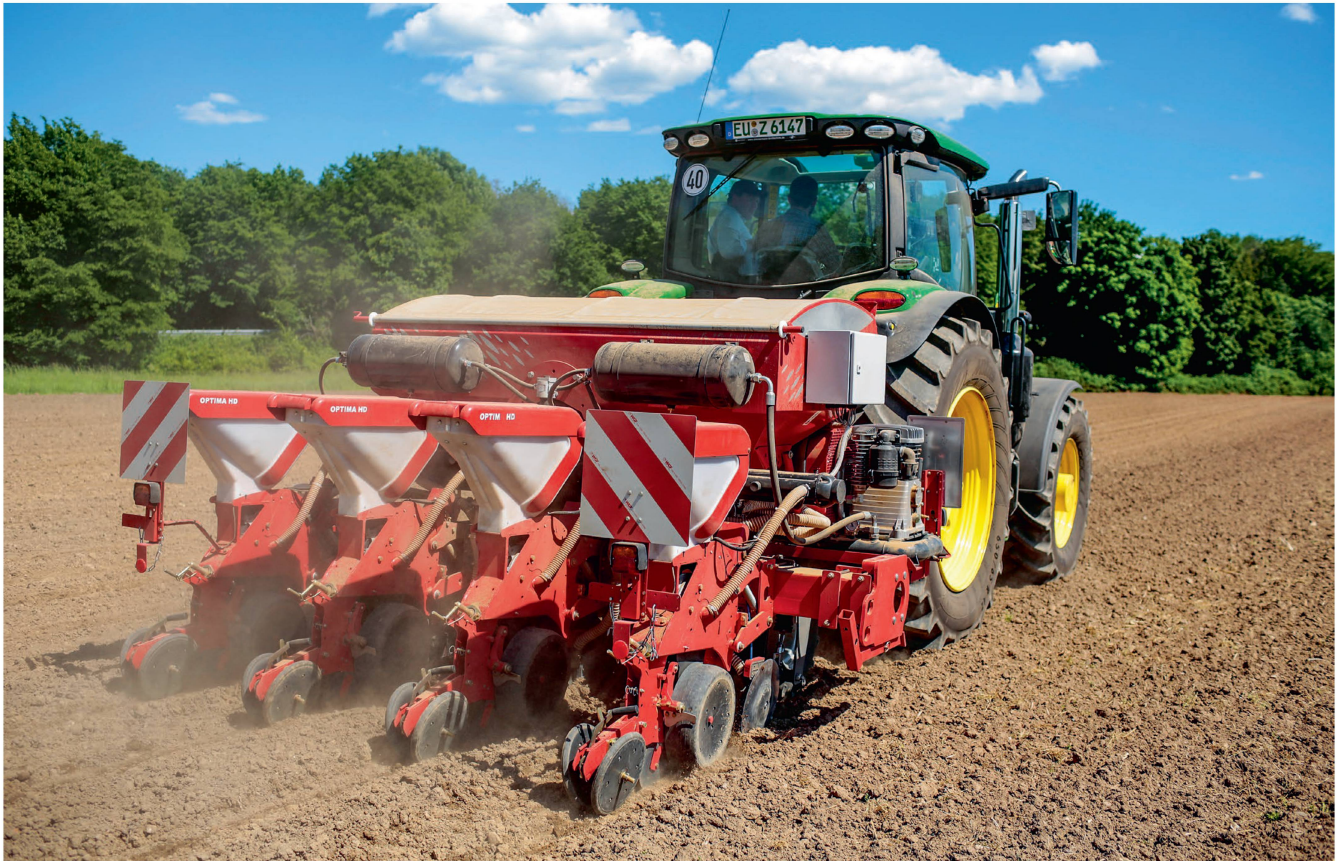
Für den Einsatz an einer herkömmlichen Einzelkornsämaschine hat die TH Köln in Kooperation mit Kverneland eine neuartige Portioniereinheit entwickelt. Bilder: TH Köln
