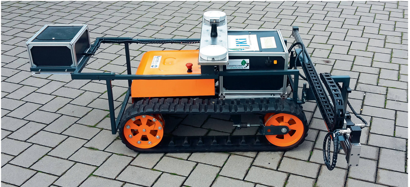
Zum ersten Mal komplett zusammengebaut, der Roboter «MSRBot» zum Ende der ersten Projektphase. Bilder: Höbing, Thomsen
