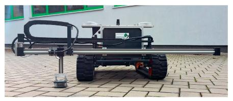
Sobald die Position der Nacktschnecke erfasst ist, fährt der Auslegearm die Nagelmatrix in Position
