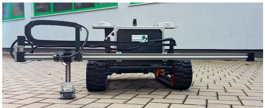
Sobald die Position der Nacktschnecke erfasst ist, fährt der Auslegearm die Nagelmatrix in Position.
