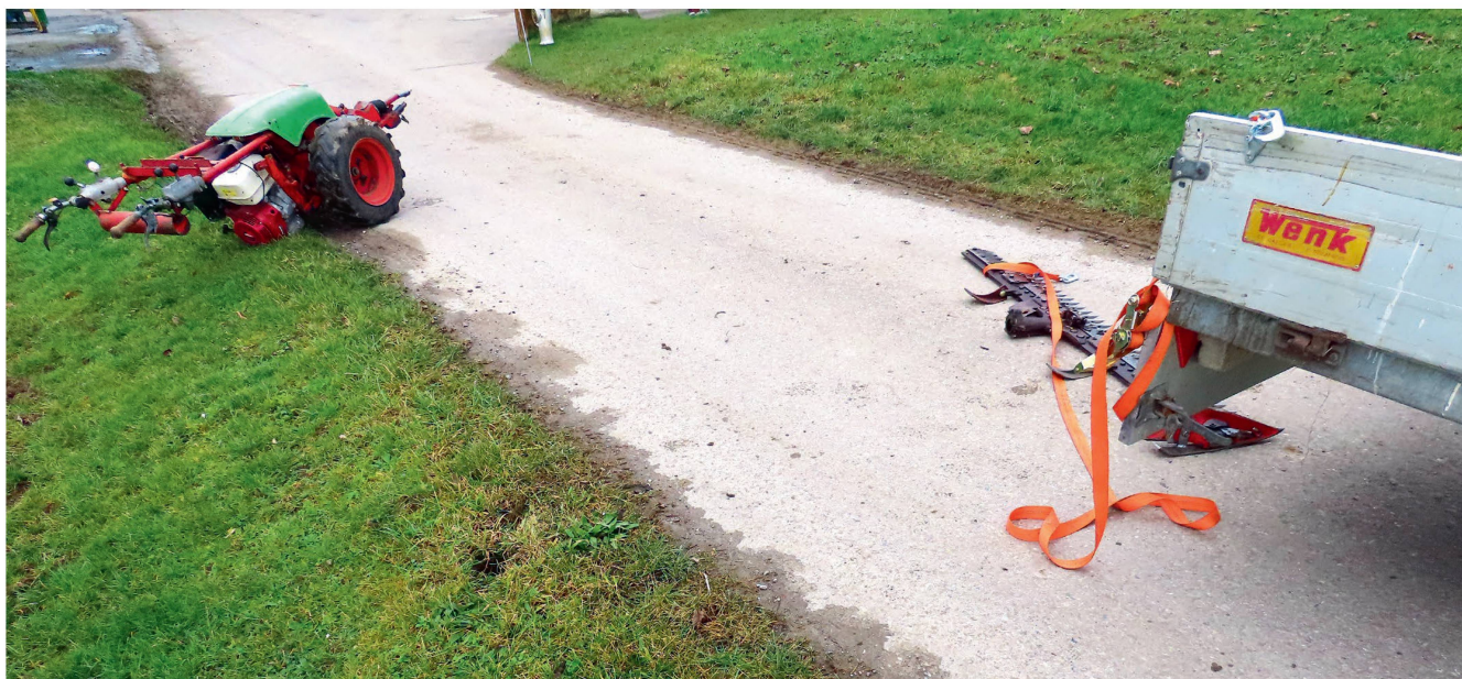
Ein «verlorener» Motormäher, weil sich der Mähbalken vom Einachser gelöst hat. Der Fahrer wollte die Maschine mit dem Mähbalken wieder kuppeln und aufladen, doch die Polizei war alarmiert und bereits vor Ort. Bild: M. Abderhalden (nachgestellte Szene)
