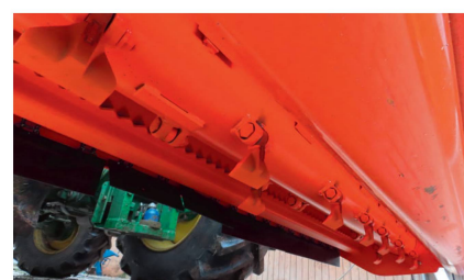
Grosse Walze und gereifte Schlegel mit gezahnter Gegenschneide.
