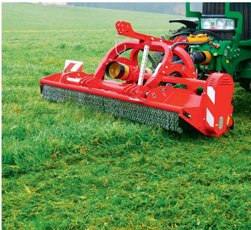
Der Mulcher Maschio «Bisonte 280» ist mit einem austauschbaren Verschleissblech im oberen Bereich ausgerüstet.
