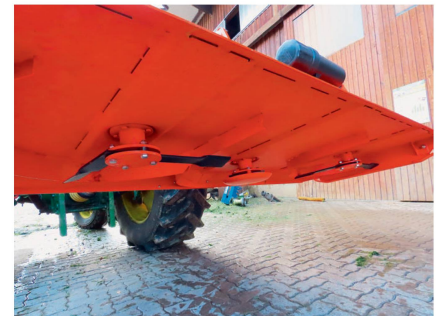
Der Mulcher ist einfach gebaut, es gibt keine Schutzkettenvorhänge.
