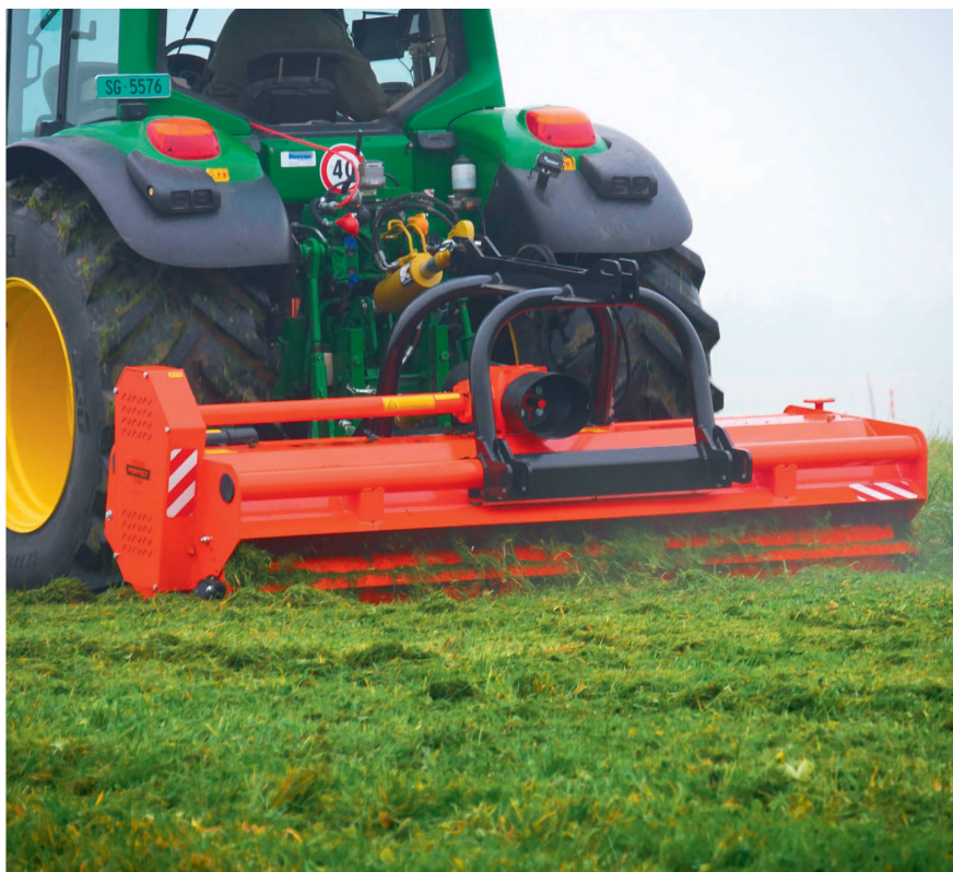
Der «Perfekt KR 270» von Van Wamel, hier im Heckbetrieb, kann auch am Fronthubwerk angebaut werden.
