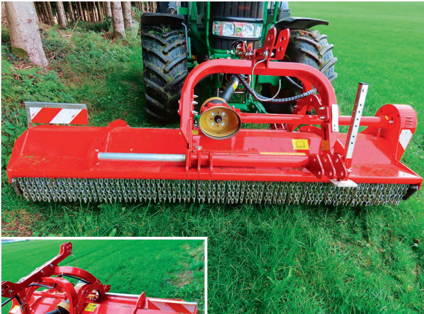
Im Frontanbau unterwegs, vorne sieht man den doppelten Kettenvorhang.
