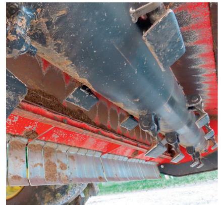
Blick auf den gross dimensionierten Rotor mit den gereihten Schlegeln.
