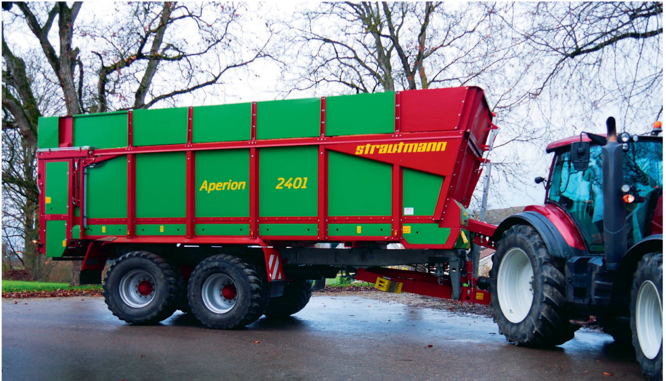
Strautmann setzt bei seinen Rollband-Wagen auf ein umlaufendes, quasi endloses Band. Bilder: R. Engeler
