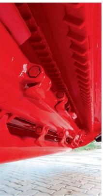
Schraubenförmig angeordnete Schlegel mit den zwei geschmiedeten Gegenschneiden.
