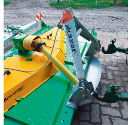
Der pendelnde Anbaubock ist einfach aber praktisch.
