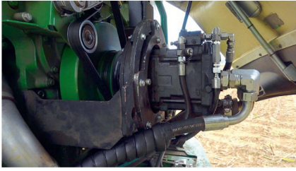
Um alle hydraulischen Funktionen des Anhängers abzudecken, wurde direkt am Motor des Häckslers eine zusätzliche Ölpumpe eingebaut.
