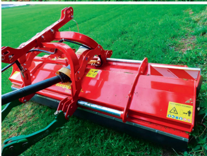
Der Anbaubock verfügt über viele Anbaumöglichkeiten und Bolzenstellungen.
