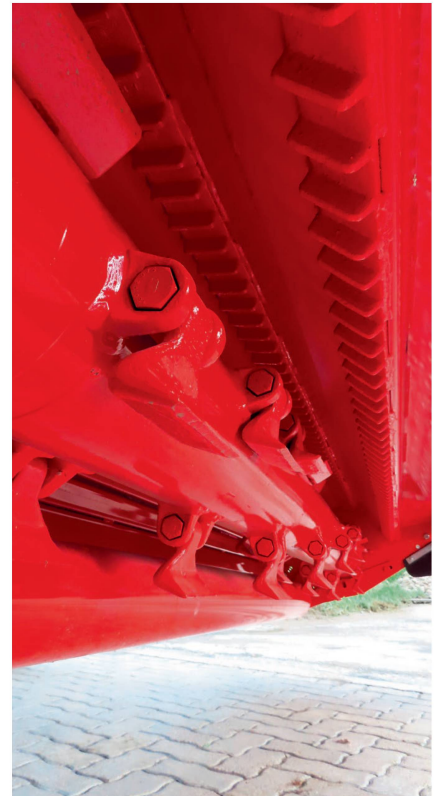
Schraubenförmig angeordnete Schlegel mit den zwei geschmiedeten Gegenschnitten.
