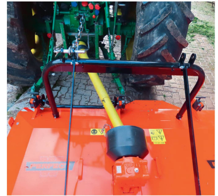
Schnellkuppler für die Unterlenker vereinfachen den Wechsel der Anbaupositionen.
