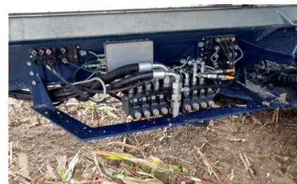
Die Aufteilung der verfügbaren Hydraulikleistung erfolgt über einen Ventilblock mit modernster «Flow-Sharing»-Technologie für alle Funktionen.
