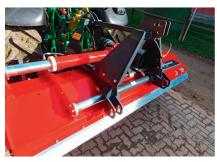
Sehr massiver Anbaubock mit schmierbarem Seitenschub und zentralem Antrieb.
