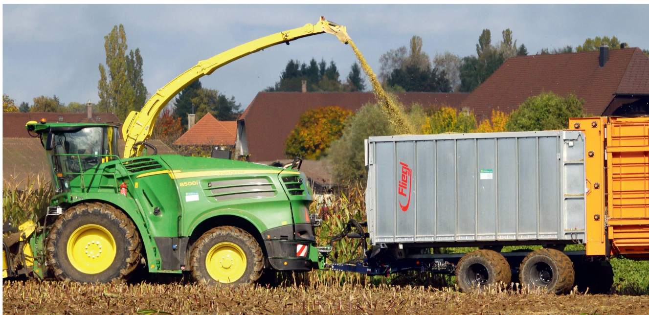
Der Überladebunker mit Lenktriebachse, Hundegang-Möglichkeit und Abschiebetechnik bei der Maisernte. Bilder: R. Burkhalter
