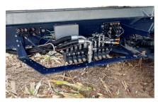
Die Aufteilung der verfügbaren Hydraulikleistung erfolgt über einen Ventilblock mit modernster «Flow-Sharing»-Technologie für alle Funktionen.
