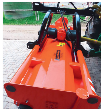
Der massive Anbaubock mit den grossen Strebenrohren.
