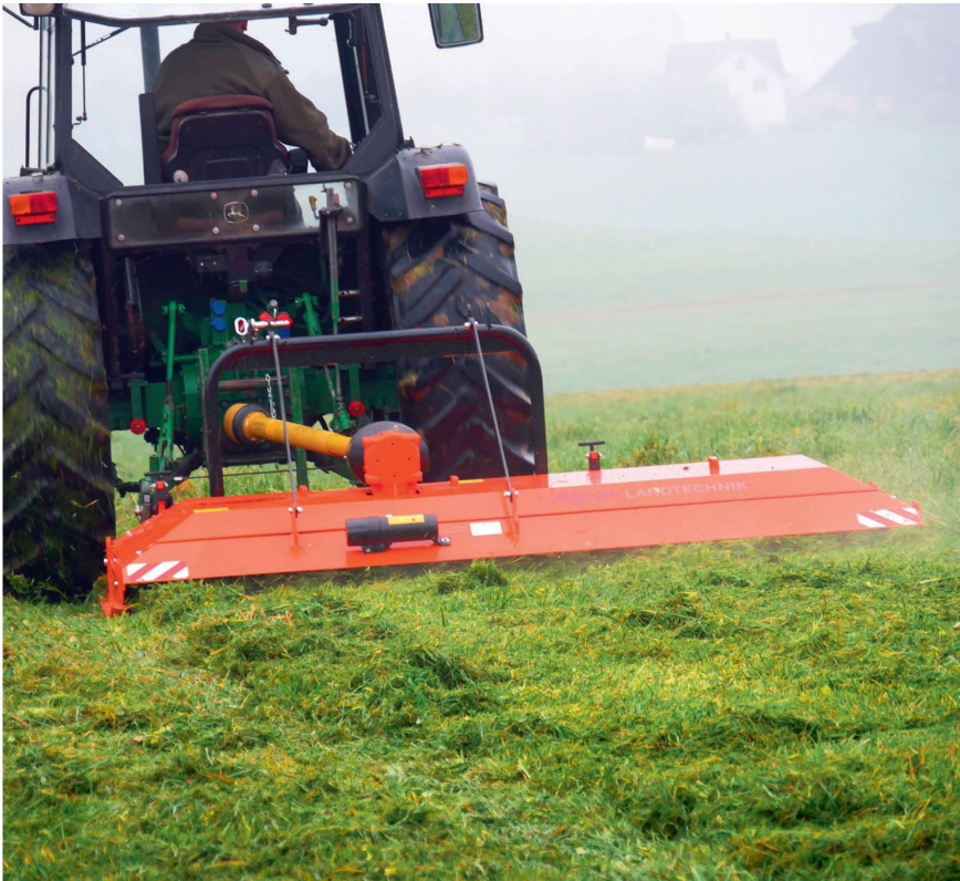
Der seitliche Versatz ermöglicht es dem «Perfekt LB 275 V» von Van Wamel, nur mit einem Rad die zu überarbeitende Fläche zu überfahren.
