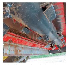
Blick auf den gross dimensionierten Rotor mit den gereihten Schlegeln.
