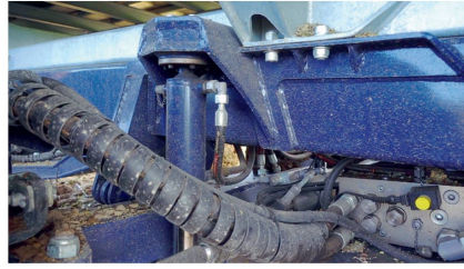
Neben der aktiven Lenkung ist dank verbauten Neigungssensoren auch ein automatischer Hangaussgleich im Achsaggregat untergebracht.
