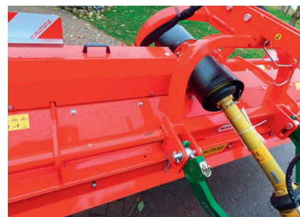
Die Schmierstelle für das Rotorlager befindet sich ausserhalb.
