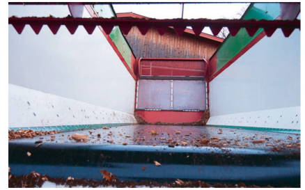
Das Band ist 2,10 m breit, 10 mm dick und mit Gewebe verstärkt. Die Seitenwände sind aus glasfaserverstärkten Kunststoffplatten gefertigt.
