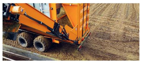
Die orange gefärbte Überladeeinheit mit vier Dosierwalzen und zweifach klappbarem Kettenelevator hat Fritz Lehmann selber entwickelt und gebaut.
