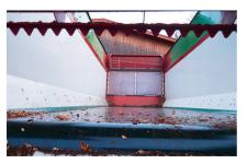
Das Band ist 2,10 m breit, 10 mm dick und mit Gewebe verstärkt. Die Seitenwände sind aus glasfaserverstärkten Kunststoffplatten gefertigt.
