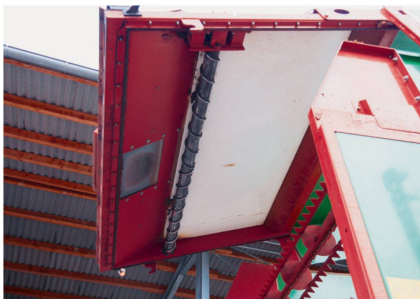
Diese zusätzlich angebrachte Walze mit aufgewandeltem Rundeisen hilft beim Ablad schlecht rieselfähiger Güter.
