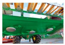
Alle drei Rotoren sind mit einem Auffahrschutz versehen.
