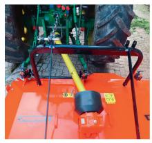
Schnellkuppler für die Unterlenker vereinfachen den Wechsel der Anbaupositionen.
