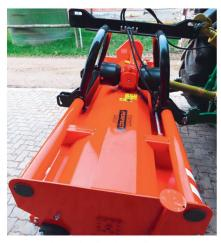
Der massive Anbaubock mit den grossen Strebenrohren.
