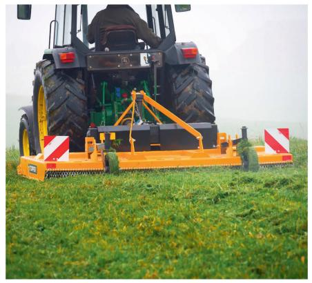
Das Gehäuse beim «Topper 9» von McConnel ist recht flach gebaut, der Dreipunkt-Anbau grossflächig abgestützt und mit einer pendelnden Oberlenkeraufnahme versehen.
