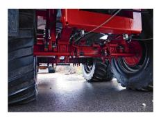
Das Tandemfahrwerk weist einen hydraulischen Achsausgleich auf und ist mit einer Nachlauflenkung versehen.
