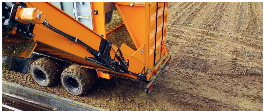
Die orange gefärbte Überladeeinheit mit vier Dosierwalzen und zweifach klappbarem Kettenelevator hat Fritz Lehmann selber entwickelt und gebaut.
