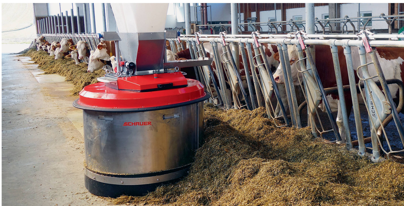
Autonome Futternachschieber bringen auf Einmann-Betrieben zeitliche Entlastung von körperlicher Arbeit. Bild: Schauer
