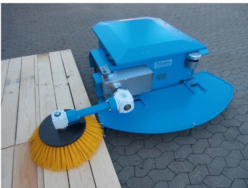
Arbeitsprinzip: Der Reinigungsroboter erkennt ob die Liegeboxe belegt ist oder nicht. Bild: Prinzing
