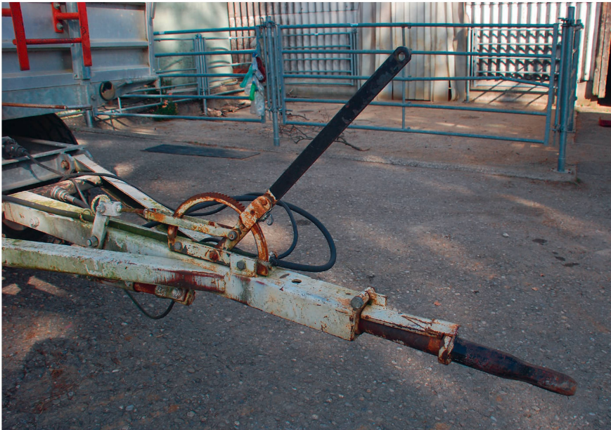
Ab Baujahr 1993 ist die Farmerstopp-Bremse nur noch als Feststellbremse zugelassen. Zusätzlicher Hinweis zu diesem Bild: Die verdrehte Zugöse müsste vom Besitzer ersetzt werden. Bild: H. Röthlisberger
