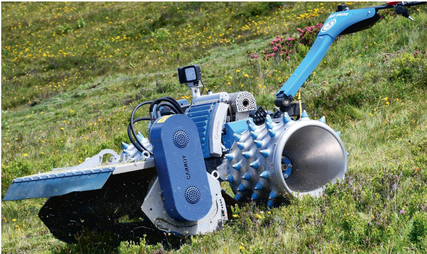
Alternativ zum Fingerbalken gibt es für den Motormäher auch Anbau-Mulchgeräte.
