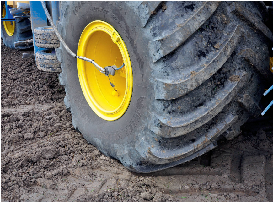
Sind Vorgaben wie Aussenmass und Abstand/Lücke zu Fahrzeug oder Reifenflanke eingehalten und im Fahrzeugausweis eingetragen, darf man mit abstehenden Leitungen von Reifendruckregelanlagen auch auf öffentlichen Strassen unterwegs sein. Bild: R. Engeler
