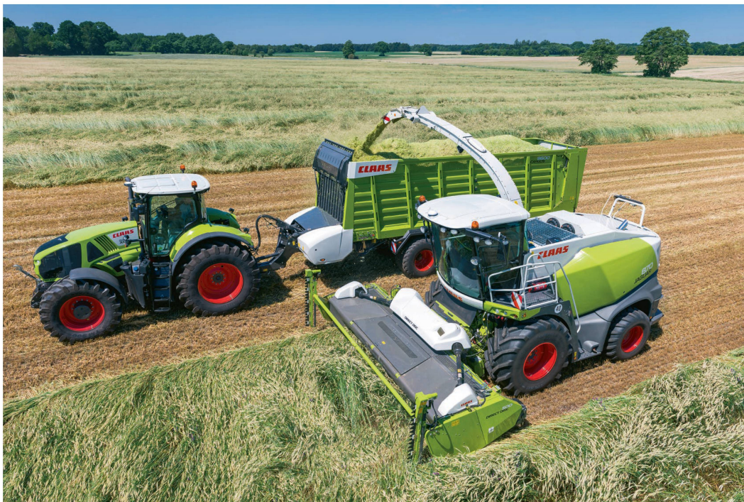
Je nach Schärfezustand erzeugen die Messer auf der Häckseltrommel spezifische Töne, die mit moderner Akustiktechnik herausgefiltert werden können. Bild: Claas
