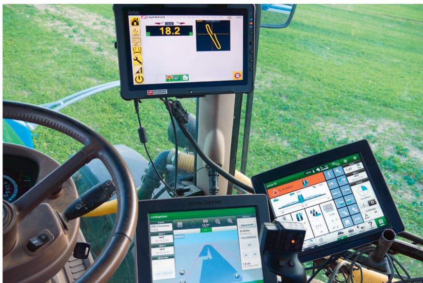
Bei der Platzierung von Terminals in der Traktorkabine ist darauf zu achten, dass diese das Sichtfeld des Fahrers nicht zu stark beeinträchtigen. Bild: R. Engeler
