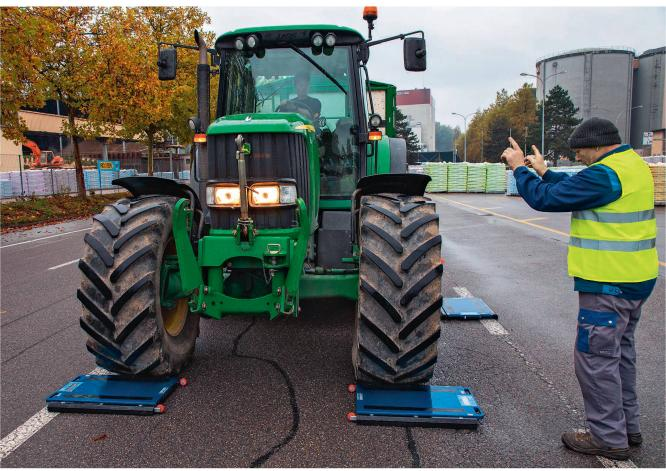
Gewichtskontrolle mit einer mobilen Waage. Überladene Fahrzeuge werden in der Schweiz streng sanktioniert. Bild: Peter Gerber, BVLT
