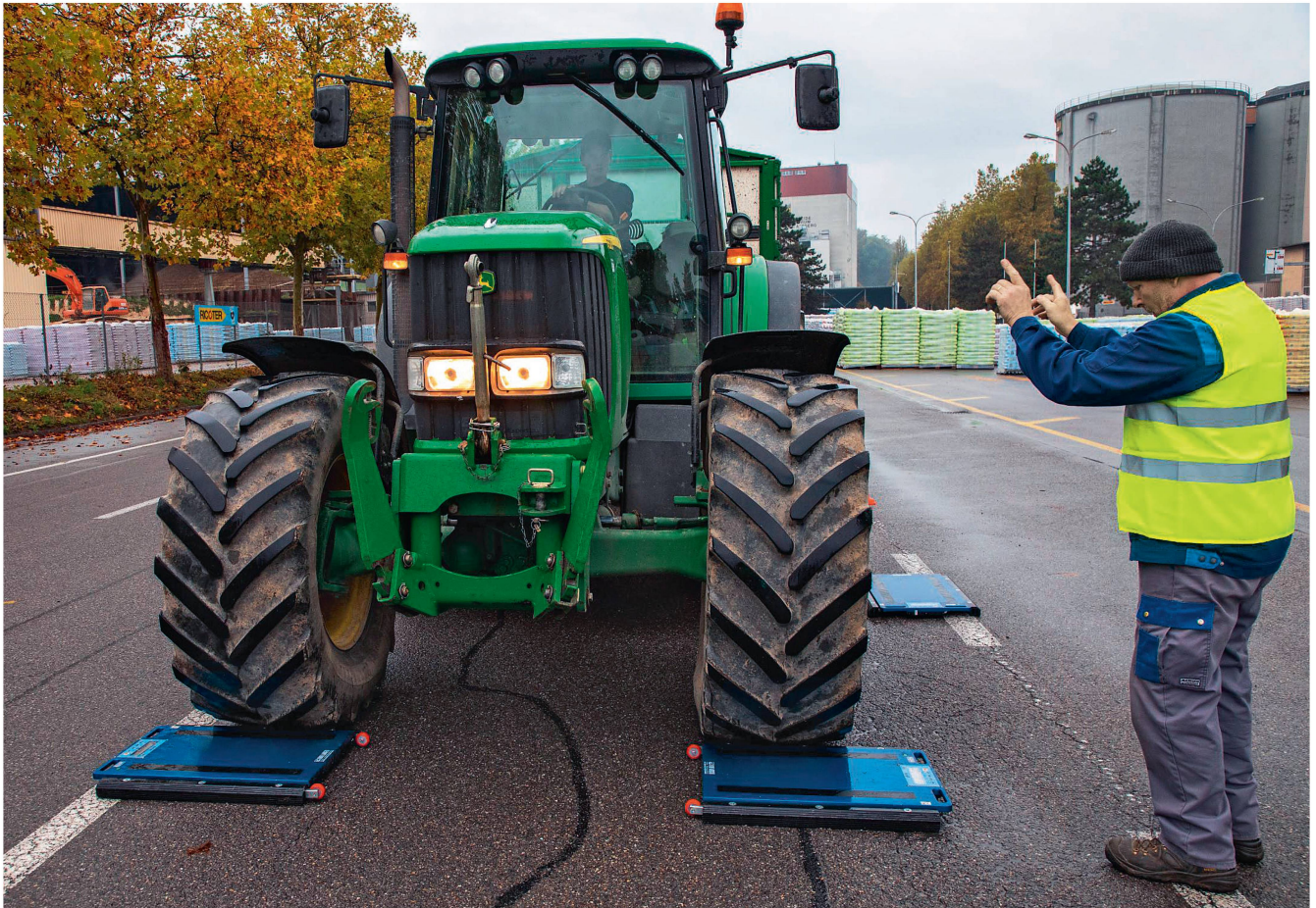
Gewichtskontrolle mit einer mobilen Waage. Überladene Fahrzeuge werden in der Schweiz streng sanktioniert. Bild: Peter Gerber, BVL
