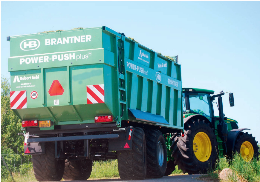
Es kann vorkommen, dass die im Fahrzeugausweis eingetragene Anhängelast beim Traktor aufgrund des geforderten Adhäsionsgewichts gar nicht erreicht werden kann. Bild: C. Jenni
