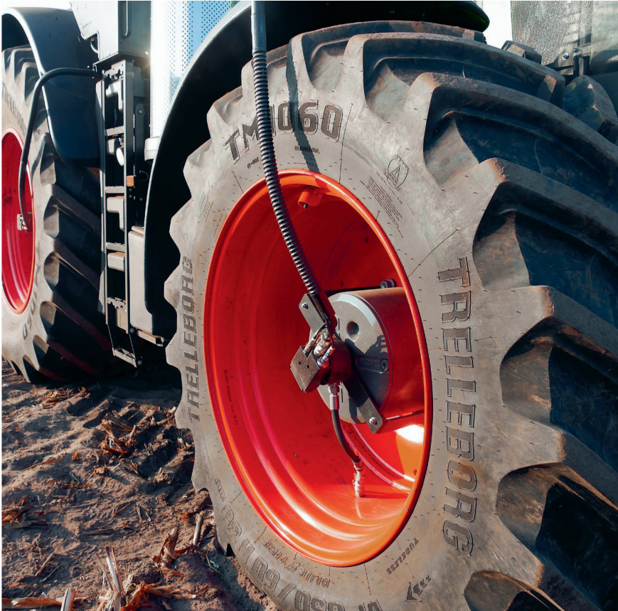
Sind Vorgaben wie Aussenmass und Abstand/Lücke zu Fahrzeug oder Reifenflanke eingehalten und im Fahrzeugausweis eingetragen, darf man mit abstehenden Leitungen von Reifendruckregelanlagen auch auf öffentlichen Strassen unterwegs sein. Bild: R. Engeler
