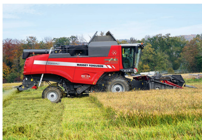
Beim Massey Ferguson «7360 Pli» können die Lamellensiebe in der Kabine auf Knopfdruck auf Reis umgestellt werden.
