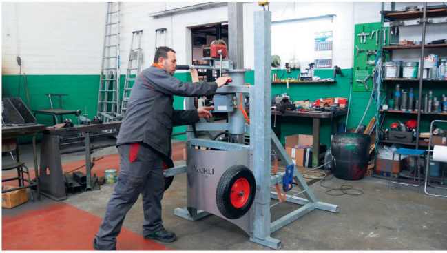
Blick in die Werkstatt in Brittnau. Hier wird gerade ein Tauchmotorrührwerk revidiert.
