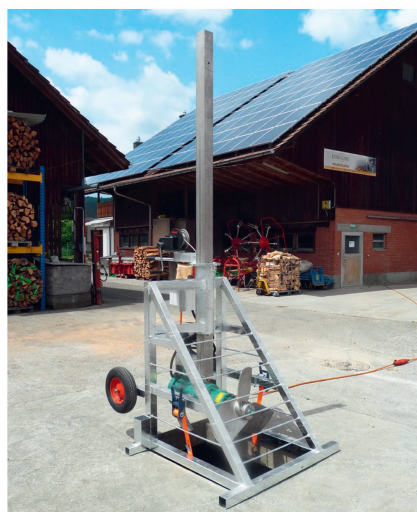
Für den Einsatz in mehreren Jauchegruben ist ein fahrbares Tauchmotorrührwerk die ideale Lösung.
