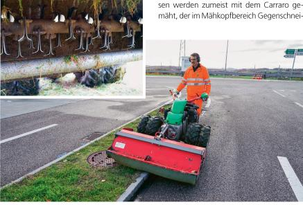
Extralange Mulchschlegel (kl. Bild) erlauben die Höherstellung der Mähwerks-Welle, damit sie den Randstein nicht touchiert.
