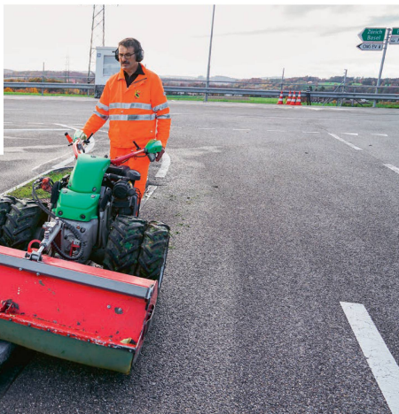
Extralange Mulchschlegel (kl. Bild) erlauben die Höherstellung der Mähwerks-Welle, damit sie den Randstein nicht touchiert.
