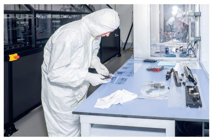
Im Coating Competence Center an der Empa nutzen die Forschenden hochspezialisierte Druckgeräte, mit denen die in Tinte gelösten Partikel auf die Unterlage aufgebracht werden. Bild: Empa
