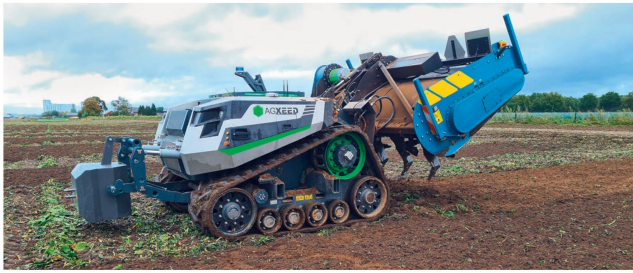
Blick auf das Raupenlaufwerk des Roboters, der diese modifizierte Spatenmaschine im Heckdreipunkt abheben kann.
