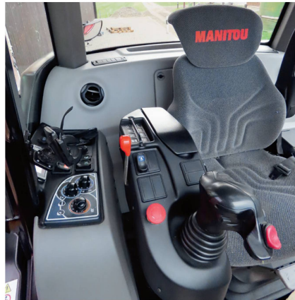
Sämtliche Bedienelemente für den Fahr-antrieb und die Hydraulik-Funktionen sind auf der in Höhe und Länge verstellbaren Armlehne sowie in der Seitenkonsole griffgünstig platziert.
