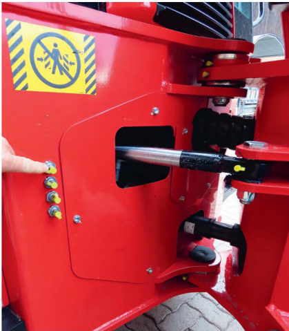
Das Knickgelenk ist massiv gebaut. Die abgedeckten Schmiernippel sind einfach zu erreichen.
