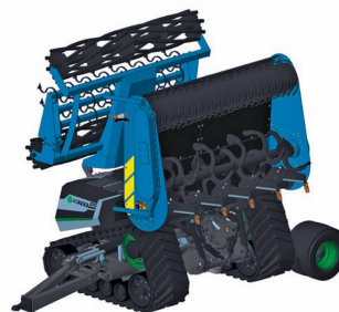
CAD-Zeichnung des Roboters mit dem Transportfahrwerk. Bild: AgXeed
