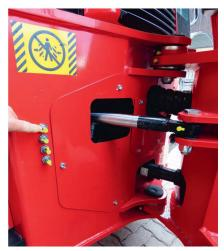
Das Knickgelenk ist massiv gebaut. Die abgedeckten Schmiernippel sind einfach zu erreichen.
