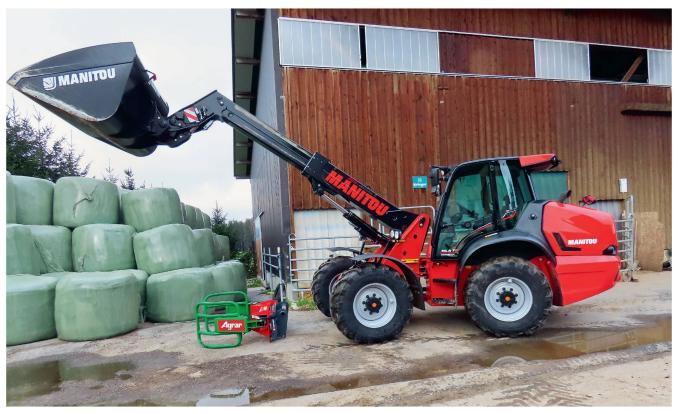
Der knickgelenkte Teleskop-Radlader «MLA-T 533-145V+» ist mit seiner Masse von 8,5 t in der Lage, Lasten über 3 t auf über 5 m zu heben. Bilder: M. Abderhalden
