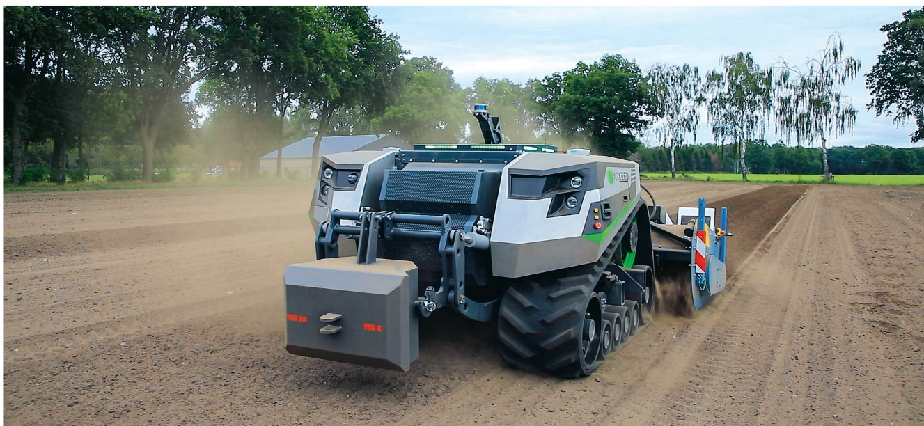
Der Roboter «Agbot» des holländischen Unternehmens «AgXeed» im Einsatz mit einer Spatenmaschine im Heck und einem Gegenwicht am Fronthubwerk. Bilder: M Nijenhuis
