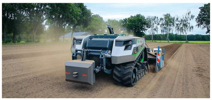
Der Roboter «Agbot» des holländischen Unternehmens «AgXeed» im Einsatz mit einer Spatenmaschine im Heck und einem Gegenwicht am Fronthubwerk. Bilder: M Nijenhius
