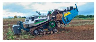
Blick auf das Raupenlaufwerk des Roboters, der diese modifizierte Spatenmaschine im Heckdreipunkt abheben kann.
